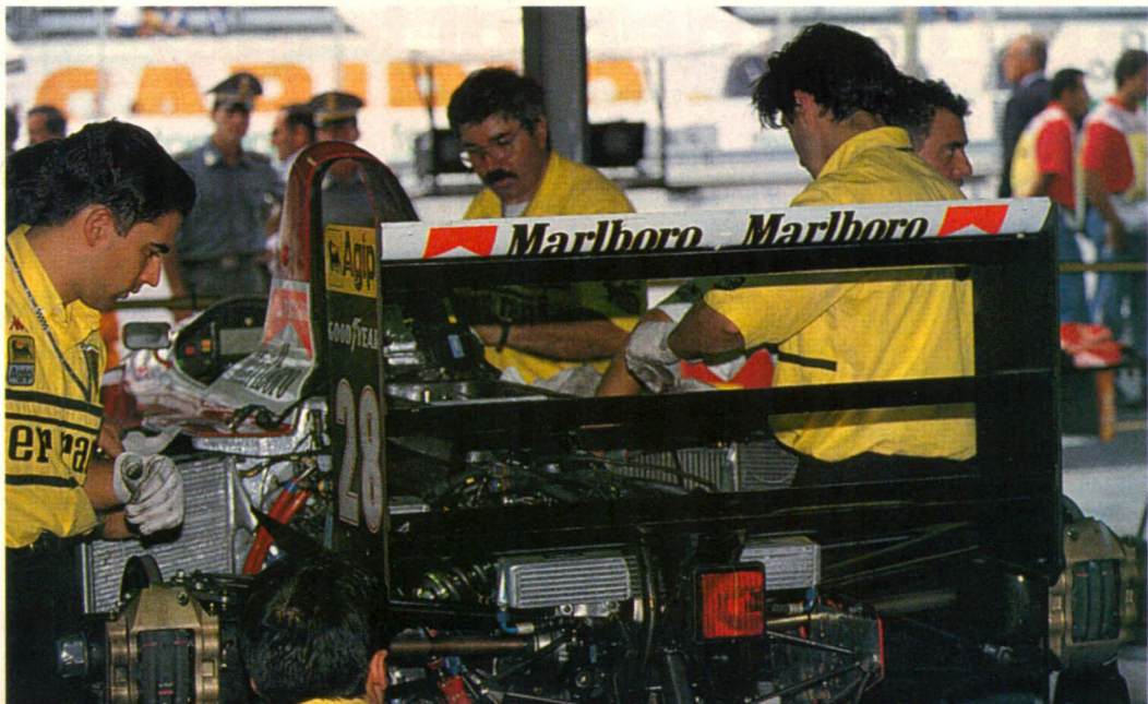
Sopra e nell'altra pagina ecco il V12 Ferrari dotato di cornetti d'aspirazione ad altezza variabile e distribuzione a quattro valvole per cilindro. Dopo essere stato utilizzato solo in prova nei tre Gp precedenti, il motore a Monza ha esordito in gara. Notare, sotto, il retrotreno della F93A, nel quale spiccano tre grosse prese d'aria. In basso l'alettone triplano con profili a corda molto ridotta, studiato appositamente per le monoposto del Cavallino in funzione del Gp d'Italia e abbinato a un nuovo sostegno centrale più corto rispetto a quello precedente
