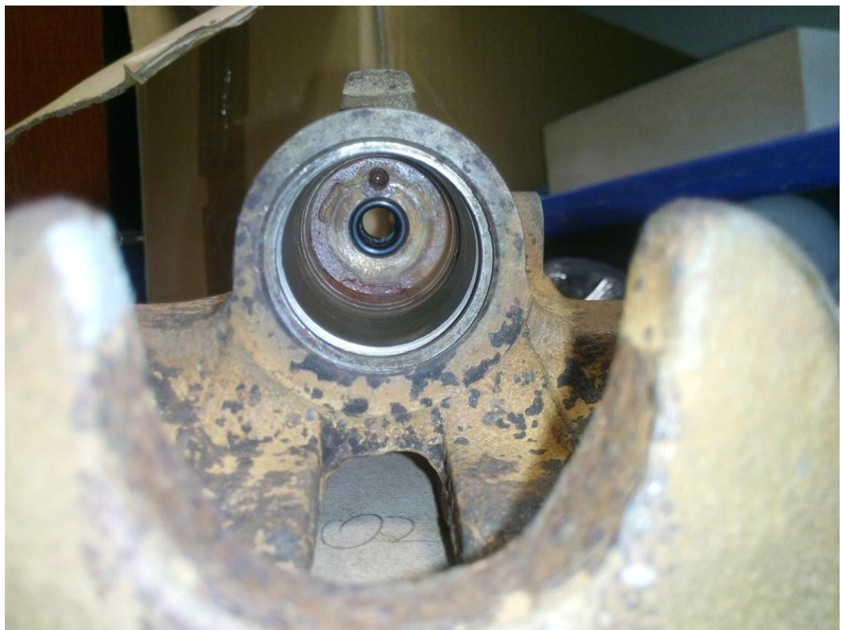
Klip ukoliko nije oštećen rastaviti (ukloniti osigurač s unutarnje strane) i očistiti obratiti pažnju da rupice na vanjskom djelu klipa nisu zaštopane
