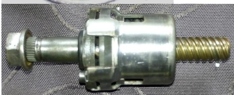
S unutarnje kočionih klješta (ispod mehanizma ručne kočnice) se nalazi brtveća gumica (nju sam izvadio i zamijenio)
