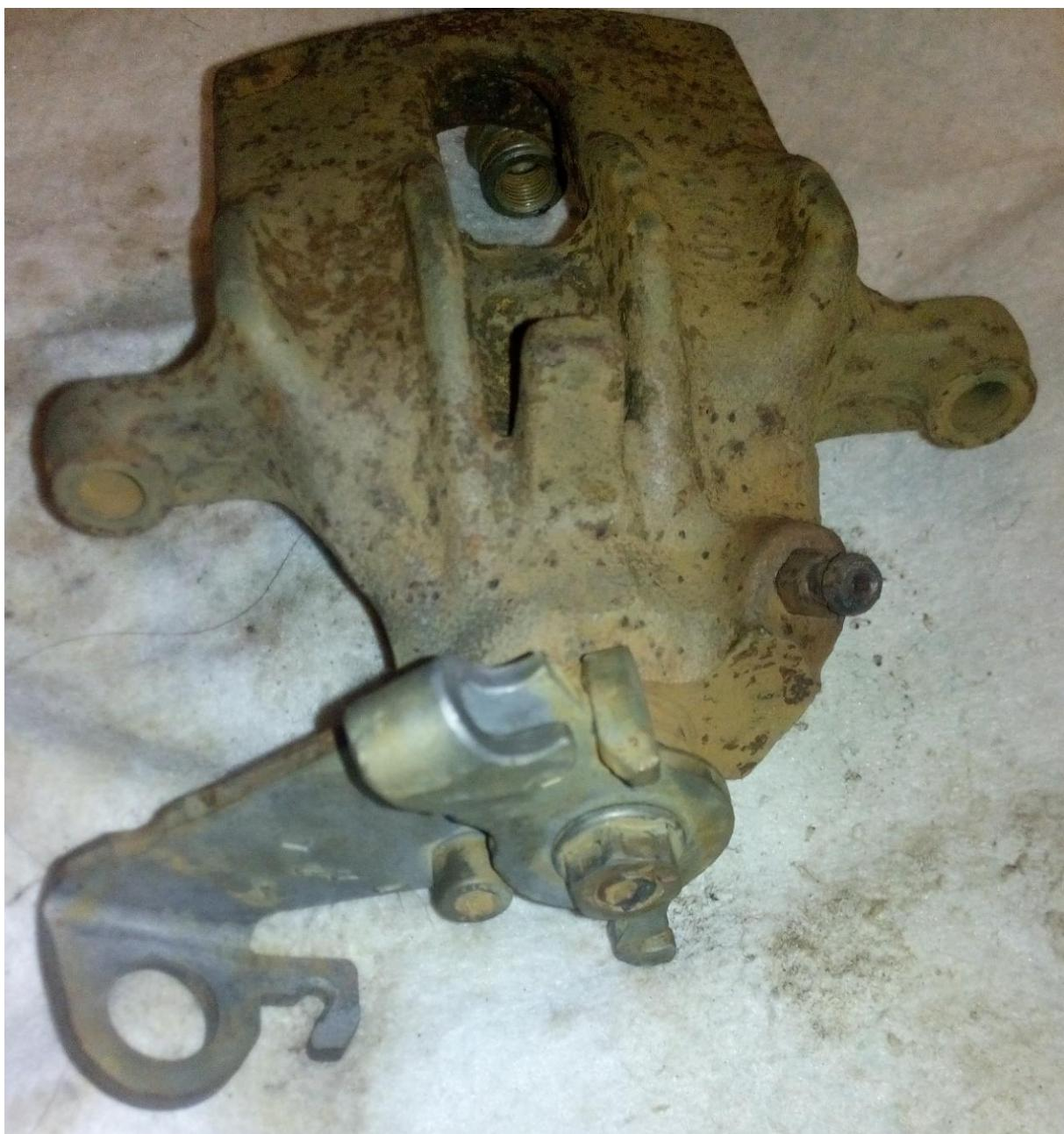
Skinuti metalni graničnik i ukloniti metalnu polugu za mehanizam ručne kočnice
