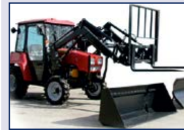
ковш ОП-300. 10.00.000/ bucket OP-300. 10.00.000 вилы ОП-300. 11.00.000/ forks OP-300. 11.00.000 отвал ОП-300. 12.00.000/ blade OP-300. 12.00.000
