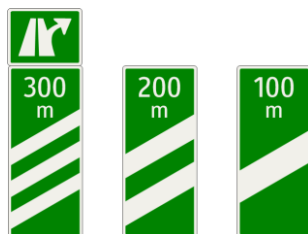
Obrázok 83: Odbočovacie dosky prípojky
