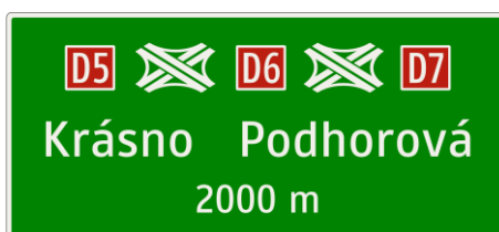
Obrázok 90: Ohlasovacia tabuľa dvoch uzlov so spoločným kolektorom
