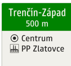
Obrázok 68: Orientačná tabuľa prízemná s bielou informačnou plochou
