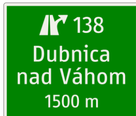
Obrázok 57: Ohlasovacia tabuľa prípojky s názvom uvedeným na dvoch riadkoch
