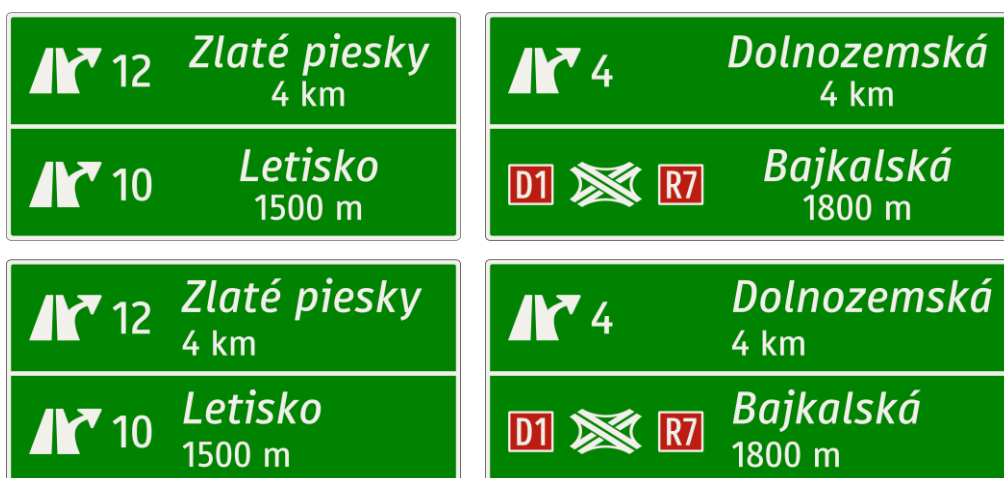
Obrázok 87: Vyobrazenia dvojitej ohlasovacej tabule s ohláškami nad sebou
