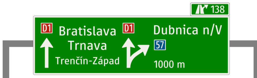
Obrázok 5: Križovatková predzvesť nad vozovkou (pruhovo orientovaná)
