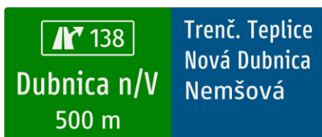
Obrázok 70: Orientačná tabuľa nad vozovkou s modrou informačnou plochou
