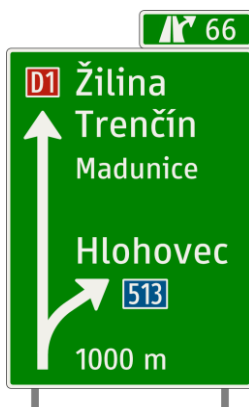
Obrázok 4: Križovatková predzvesť postranná (pásovo orientovaná)
