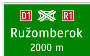
Obrázok 84: Vzorová ohlasovacia tabuľa uzla
