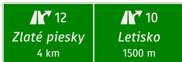
Obrázok 86: Vyobrazenie dvojitej ohlasovacej tabule s ohláškami vedľa seba
