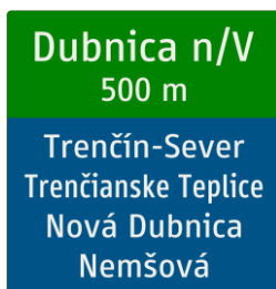
Obrázok 67: Orientačná tabuľa prízemná s modrou informačnou plochou
