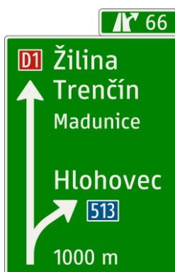
Obrázok 58: Prízemná križovatková predzvešť (prípojka)
