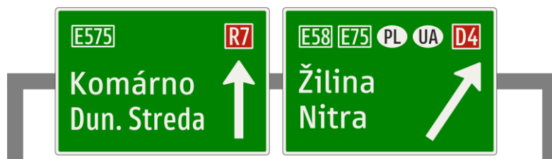
Obrázok 14: Rozdeľovacia návesť nad vozovkou pred deliacim ostrovčekom (pruhovo orientovaná)
