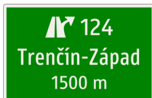
Obrázok 56: Ohlasovacia tabuľa prípojky
