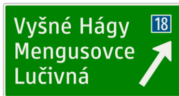
Obrázok 75: Jednoduchá križovatková návesť – vysoký formát
