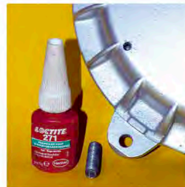
9: Abschmiegeln der Vorderseite. 8: die neu lackierte Bremstrommel. 9: der selbst hergestellte Stehbolzen mit der Schraubensicherung Loctite 271.
