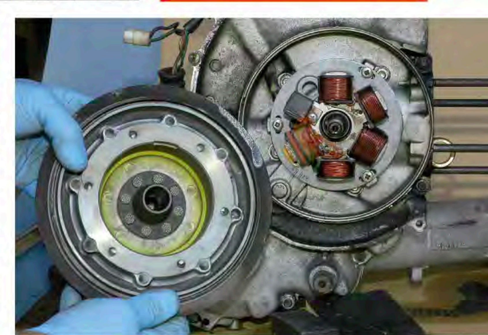
4: Der Rotor-Abzieher wird bis zum Anschlag in das Gewinde geschraubt. 5: Mit dem Ringschlüssel SW 19 wird die Abdrückschraube gegen den Kurbelwellenstumpf gedreht, bis der Rotor mit einem Knacken freikommt. 6: Rotor mit Abzieher und freiliegendem Stator. 7: Blick auf die Innenseite des Polrads und auf den noch befestigten Stator. 8: Markierung der Zündgrundeinstellung beachten und für den späteren Einbau festhalten. 9: Den Keil, der den Rotor gegen Verdrehen sichert, mit einem Seitenschneider vom Kurbelwellenstumpf abziehen und sorgfältig aufbewahren. 10: Roter Pfeil: Pickup. Gelbe Pfeile: Befestigungsschrauben des Stators. Man sieht die Schlitzlöcher für das Verdrehen des Stators zur Zündeneinstellungskorrektur. 11: Verräterisch: die Ankerplatte der Lichtmaschine stammt vom April 1992; sie wurde also schon einmal ausgetauscht.
