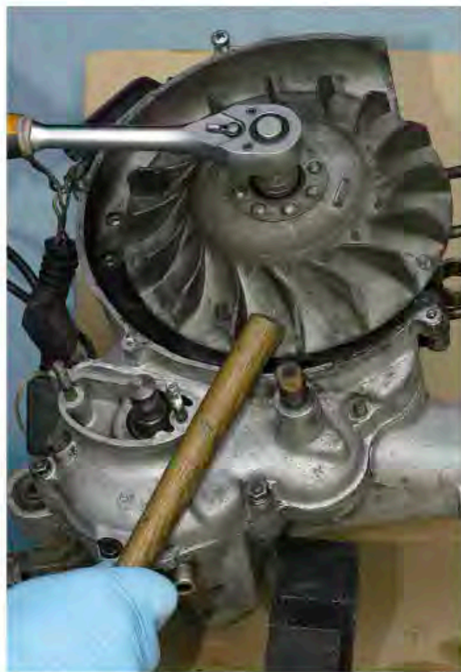
1: Der Rotor wird (mangels Piaggio-Werkzeug) über eine Gebläseschaufel mit einem passenden Holz oder Hammerstiel blockiert. Gleichzeitig wird die Mutter SW 19 gelöst. 2: Unter der Mutter sitzt eine Federscheibe. 3: Gewinde leicht einsprühen.
