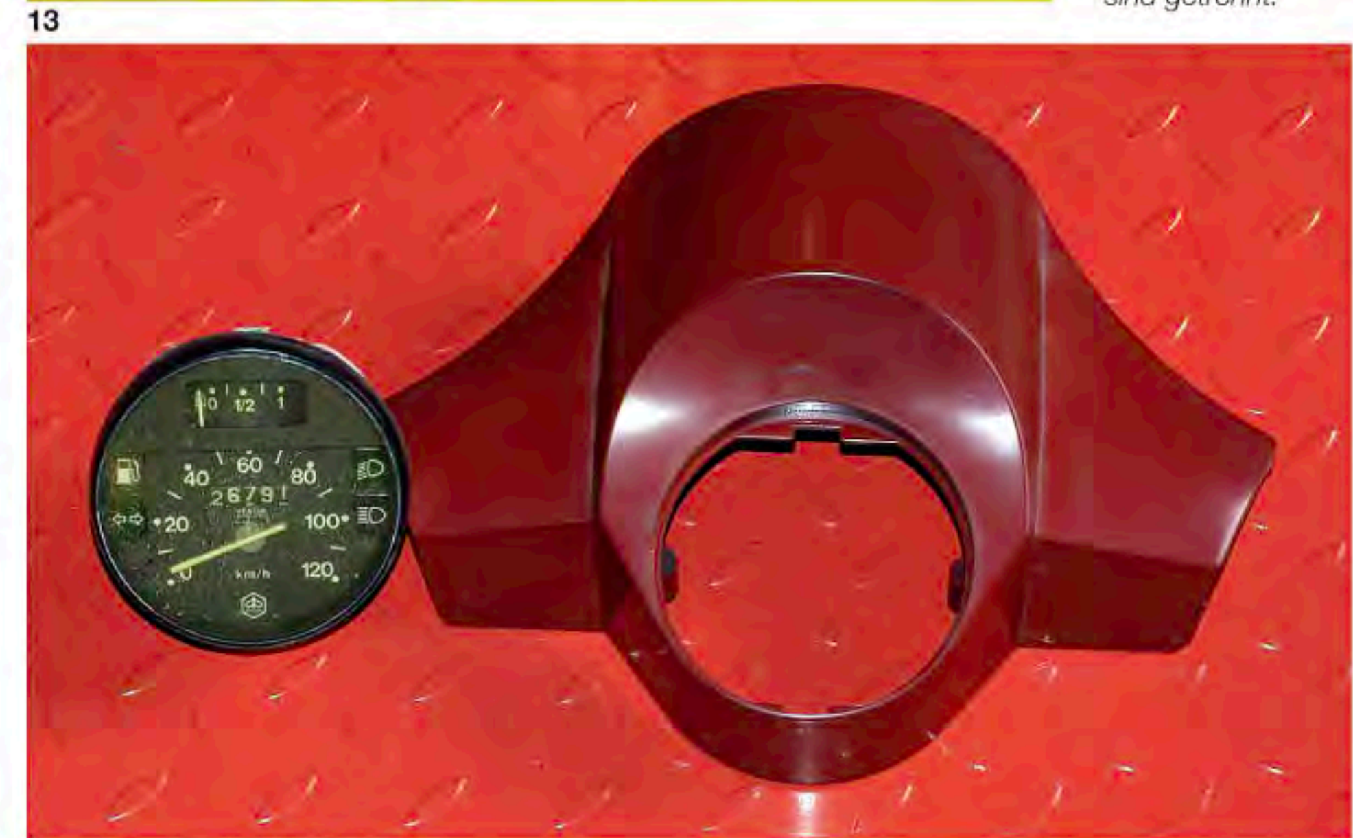
11: Durch Niederdrücken der beiden Laschen kommt das Instrument frei. 12: Benzinuhrverschraubung (blaue Pfeile), Tachoverschraubung (rote Pfeile), die vier Sockel der Instrumentenbeleuchtung (gelbe Pfeile). 13: Sockel mit Lämpchen und Gummidichtung (diese nicht mehr lieferbar, wird wiederverwendet). 14: Instrument und Lenkerverkleidung sind getrennt.
