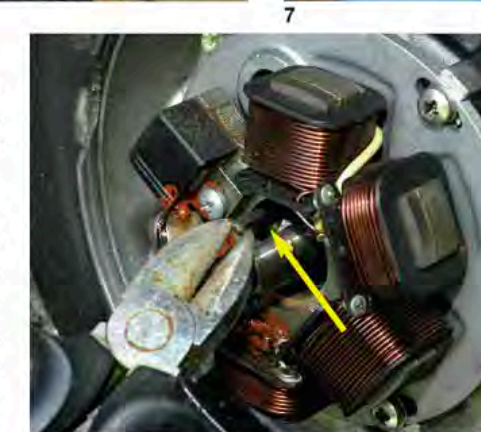
4: Der Rotor-Abzieher wird bis zum Anschlag in das Gewinde geschraubt. 5: Mit dem Ringschlüssel SW 19 wird die Abdrückschraube gegen den Kurbelwellenstumpf gedreht, bis der Rotor mit einem Knacken freikommt. 6: Rotor mit Abzieher und freiliegendem Stator. 7: Blick auf die Innenseite des Polrads und auf den noch befestigten Stator. 8: Markierung der Zündgrundeinstellung beachten und für den späteren Einbau festhalten. 9: Den Keil, der den Rotor gegen Verdrehen sichert, mit einem Seitenschneider vom Kurbelwellenstumpf abziehen und sorgfältig aufbewahren. 10: Roter Pfeil: Pickup. Gelbe Pfeile: Befestigungsschrauben des Stators. Man sieht die Schlitzlöcher für das Verdrehen des Stators zur Zündeneinstellungskorrektur. 11: Verräterisch: die Ankerplatte der Lichtmaschine stammt vom April 1992; sie wurde also schon einmal ausgetauscht.
