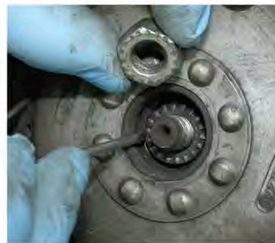
1: Mit einer Lehre wird die Steigung des Gewindes ermittelt; sie beträgt 1,0 mm. 2: In ein 28 mm dickes Rohrstück wird das passende Gewinde geschnitten. Auf das Ende wird eine starke Mutter hartgelötet. In ihr Gewinde wird eine Schraube gedreht, mit der der Rotor dann abgedrückt wird.
