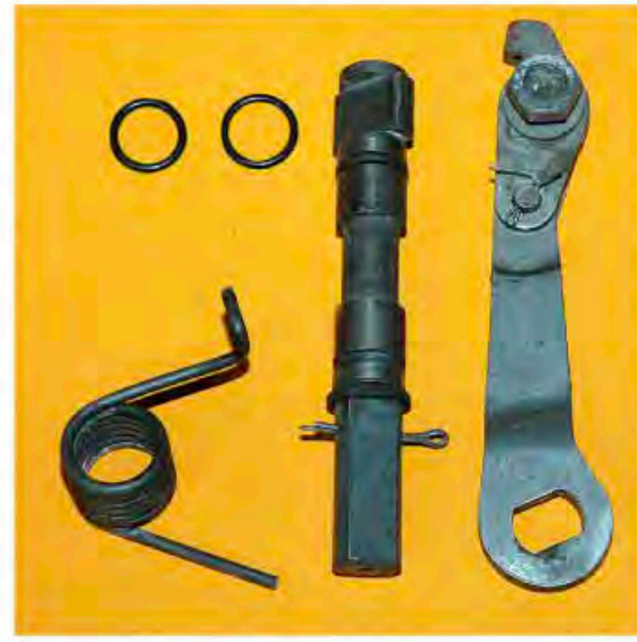
1: Rückholfeder, Nockenwelle und Bremshebel werden wiederverwendet, die O-Ringe sind neu. 2: Die Vertiefung wird mit Universalfett gefüllt.
