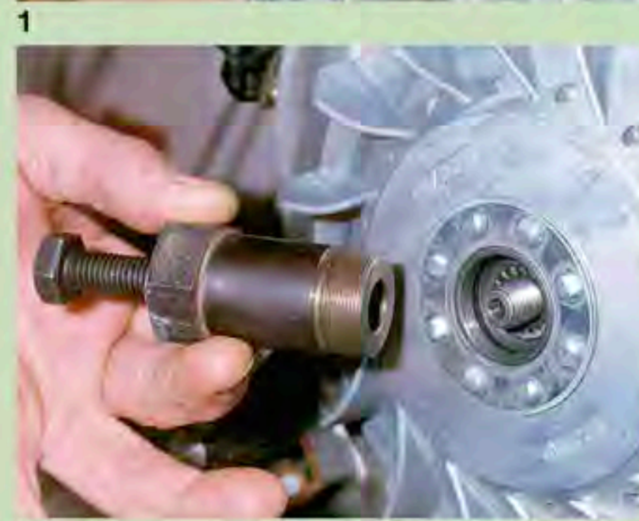
1: Mit einer Lehre wird die Steigung des Gewindes ermittelt; sie beträgt 1,0 mm. 2: In ein 28 mm dickes Rohrstück wird das passende Gewinde geschnitten. Auf das Ende wird eine starke Mutter hartgelötet. In ihr Gewinde wird eine Schraube gedreht, mit der der Rotor dann abgedrückt wird.
