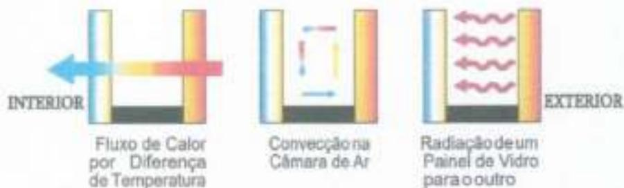
Esquema de Fluxo de Calor por Diferença de Temperatura em um Vidro Insulado | Fonte: AGC (2015)
