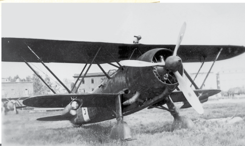
Une belle photographie d'un CR 42CN montrant clairement ses deux projecteurs sous les ailes inférieures ainsi que la génératrice sur l'aile supérieure.
