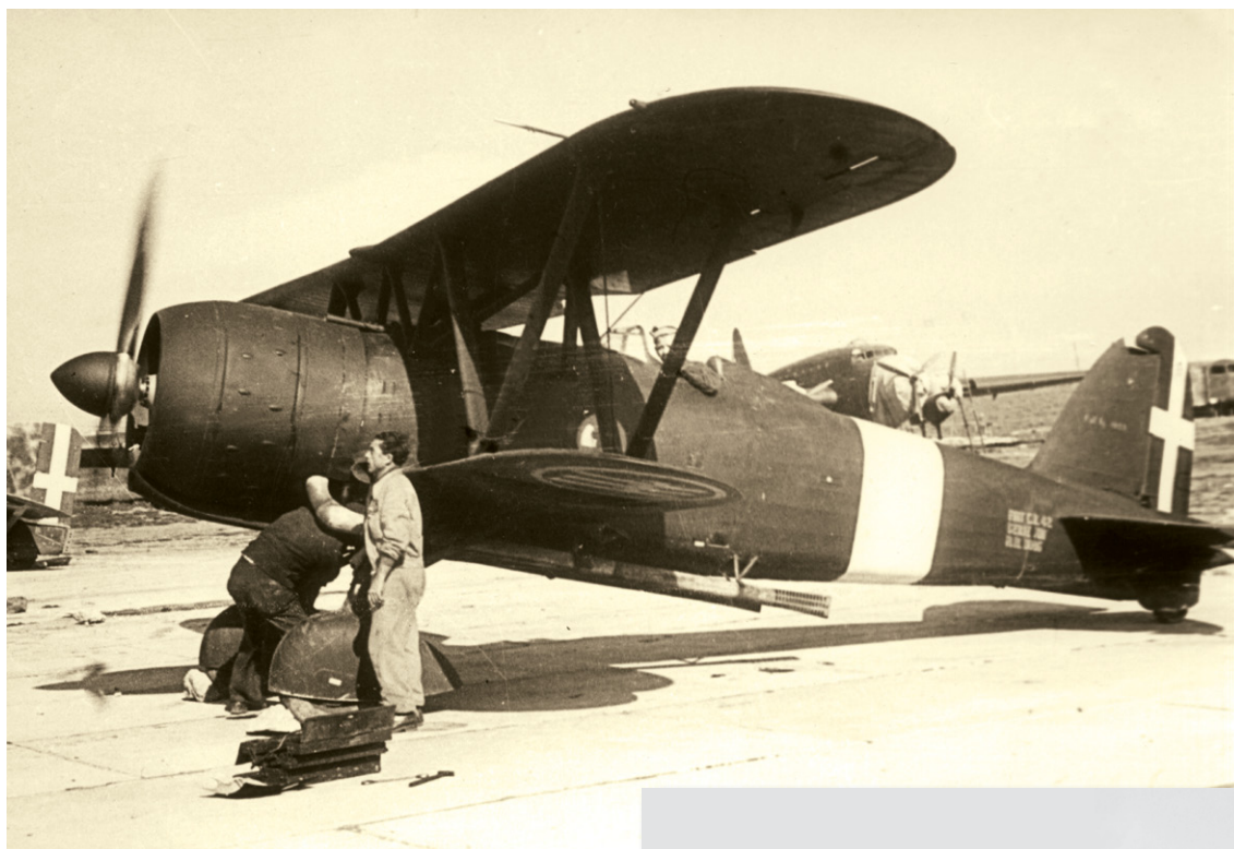
Un CR 42CN adapté à la mission de chasse de nuit grâce au montage des longues pipes d'échappement ; il a été entièrement peint en noir.
