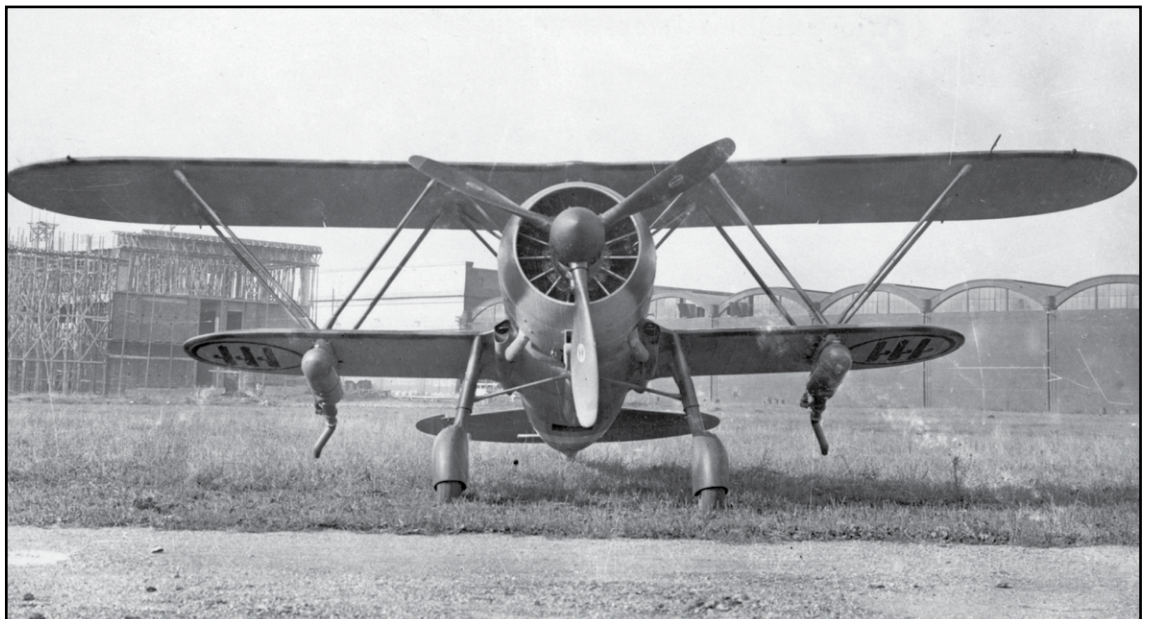
Un FIAT CR 42AS équipé de deux générateurs de fumée sous la voilure.
