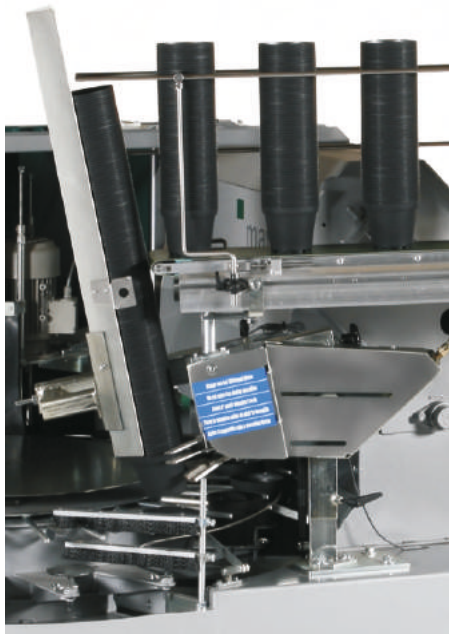
Dépilleur de pots à une rangée 1010-M001 Desapilador de macetas de una fila 1010-M001
