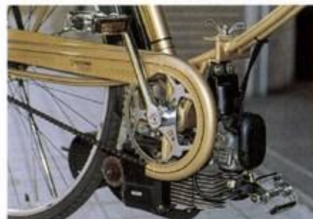
ペダル下のエンジンで後輪に駆動力を与える
