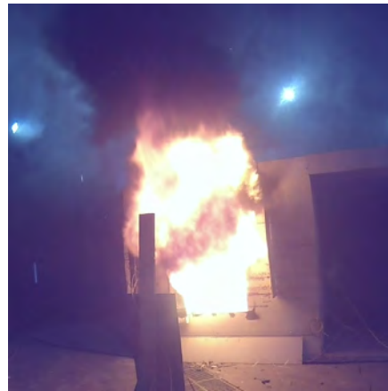
(d) Exhaust With Fan Flow - Post Flashover
