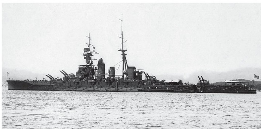
▲ Le Hiei en juin 1926 à Sasebo. La première cheminée est dotée d'un capot en forme d'angle, très caractéristique des premières modifications apportées aux bâtiments de ligne japonais que l'on retrouve également sur les Nagato . Cela est destiné à limiter l'envahissement des passerelles par la fumée.
