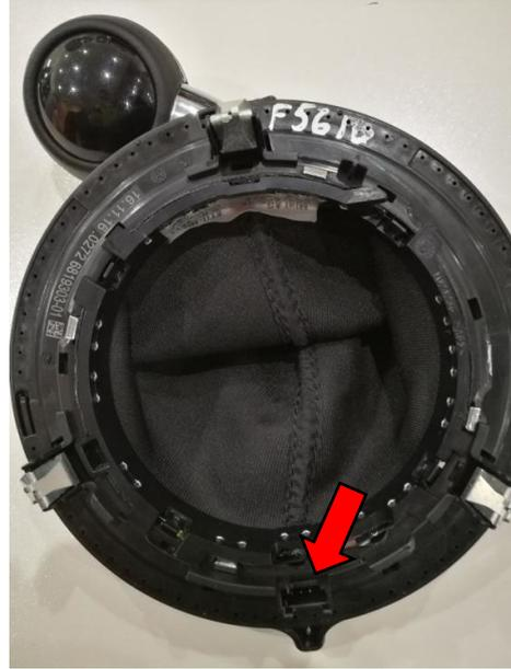
Retirez le pommeau de vitesses en le tirant vers le haut. La nouvelle bague est en fait un sélecteur. (flèche verte), le bouton est emboîté, il n'y en a pas dans la partie inférieure il y a trois contacts à vis et il ne doit pas être tourné du tout. puis connectez à l'unité de contrôle BDC.
