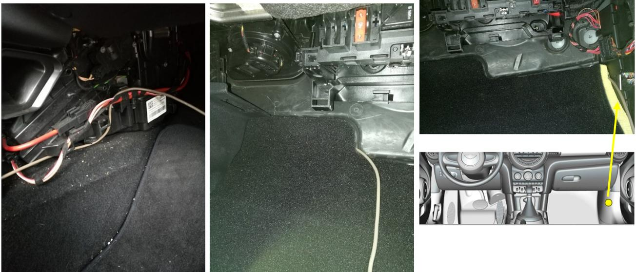
Faites passer le câble en suivant, dans la mesure du possible, l'autre câblage électrique du chauffage, puis passez-le sous le tapis jusqu'à atteindre l'unité de contrôle BDC.
