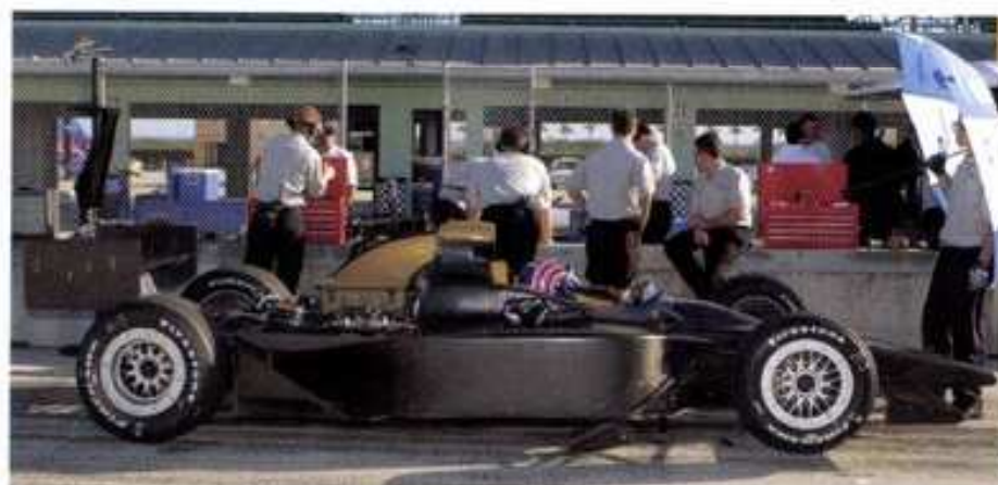
エンジンカウルを外したところ。サイドポンツーンはほぼ水平。リヤサスペンションはプッシュロッド
