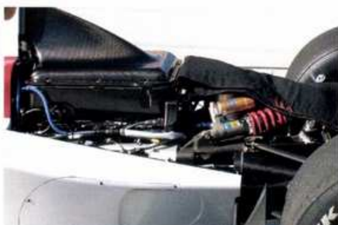
エンジンカウルを外したところ。リヤサスペンションのダンパーが見える
