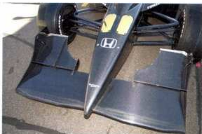
無段階で角度調整ができる、フロントのウイングフラップ
