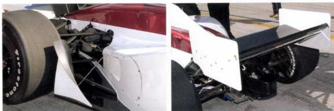
サイドポンツーン後部は大きく絞られ、リヤウイング下へと空気を流す
