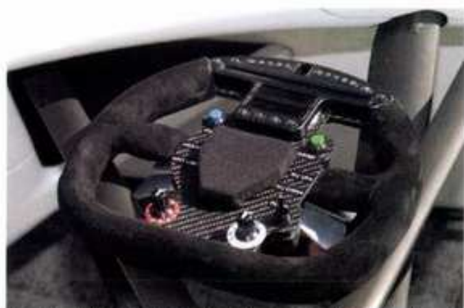
走行中にさまざまな情報をドライバーに伝えるステアリングホイール
