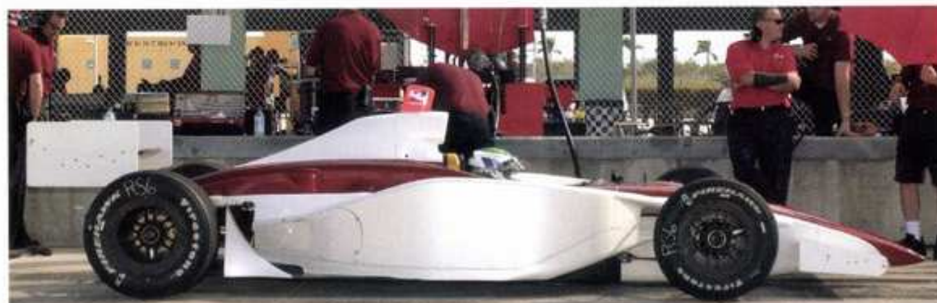
一見、厚く思われるサイドポンツーンは最上段の写真で分かるように、コクピット側に向かって傾斜。滑らかな上面と合わせ、空力的にまとまっている
