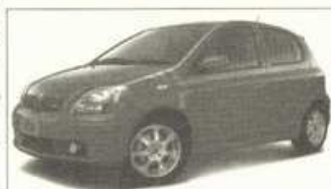
1500ccのヴィッツRSをベース車両としたカスタマイズ車はリッターあたり100馬力のハイパワーを実現
