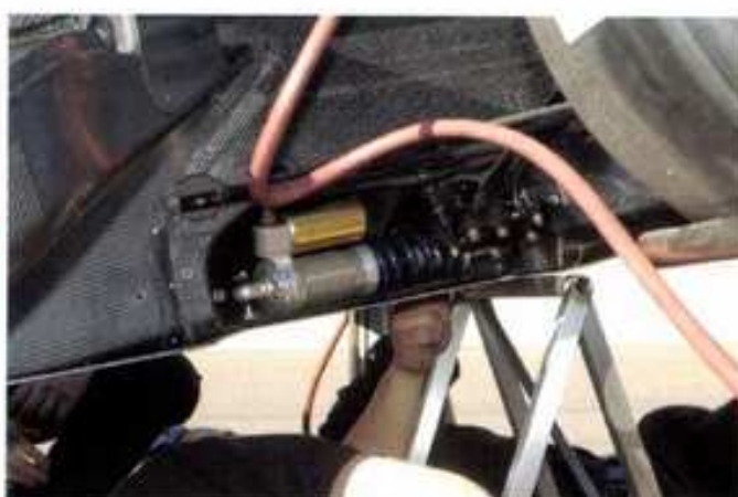
フロントノーズ下部に収められたダンパーユニット。整備性は「A」
