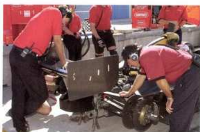
Gフォースと同じく、ギヤボックスにはカーボン製のバンパーが付く
