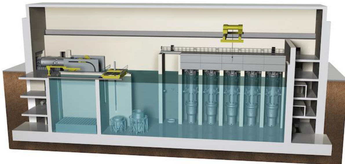
Z3_Rys.1 Przekrój budynku reaktora 175
