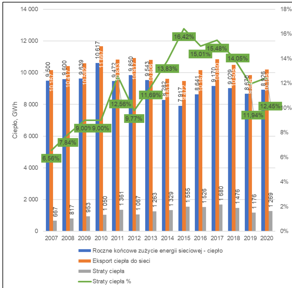
Roczne końcowe zużycie ciepła sieciowego, eksport ciepła do sieci oraz straty ciepła w latach 2007-2019
