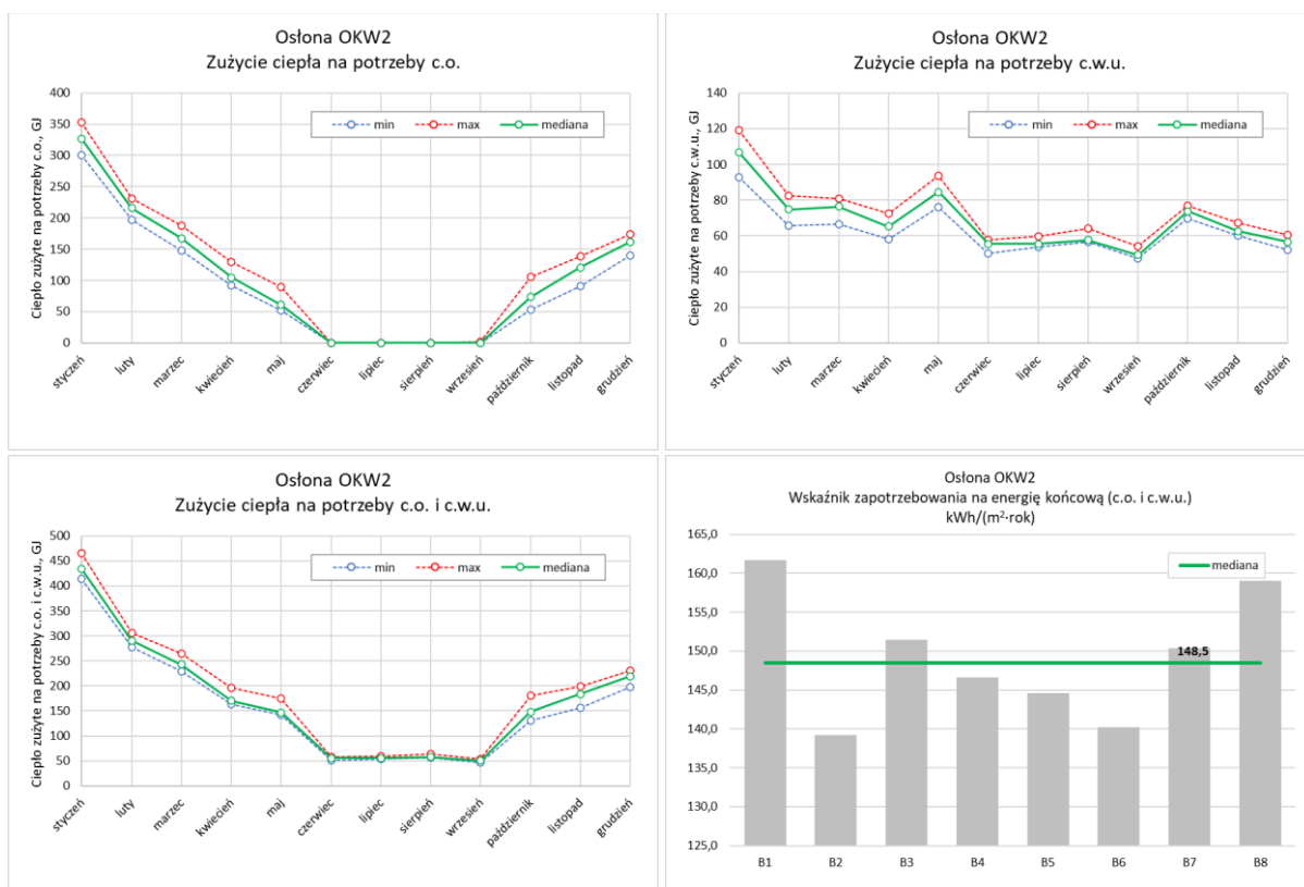
Z5_Rys. 2. Wykresy zmienności zużycia ciepła w budynkach oraz wartość wskaźnika zapotrzebowania na energię końcową (B1...B8 – numery budynków) – osłona OKW2
