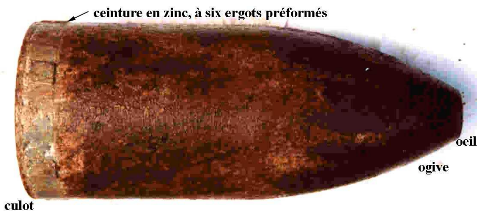
Projectile de 25 cm pour Minenwerfer lourd, chargé en toxique suffocant ou en explosif.
