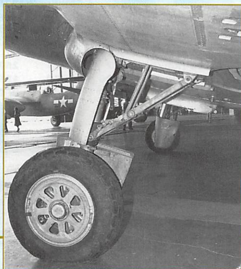
Gros plan sur l'atterrisseur gauche. Le train d'atterrissage est celui du Chance Vought F4U «Corsair» avec quelques modifications pour supporter la plus grande masse de l'avion. Pour s'éclipser, il pivote sur lui-même et se range à plat dans l'aile. (Gary Brownstein/AAHS)
