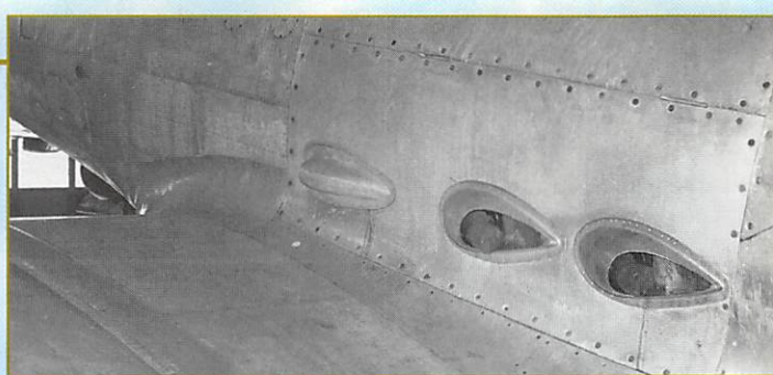
Sur le moteur Allison V-3420, il y a deux collecteurs d'échappement par banc de six cylindres. (Gary Brownstein /AAHS)
