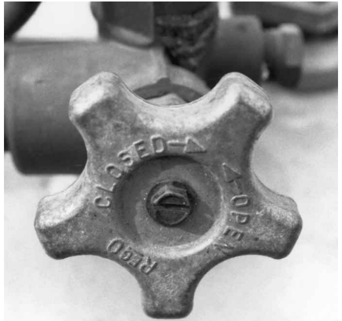
Figura 14.27 Los cilindros de gas combustible comprimido tienen un válvula de cierre que indica claramente la dirección de funcionamiento.
