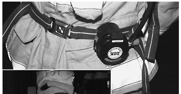
Figura 4.36 El cinturón ayuda a distribuir el peso del cilindro.
