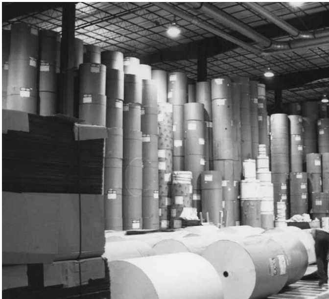
Figura 16.6 El almacenaje de papel enrollado puede ser peligroso para los bomberos. Si se mojan los rollos de la parte inferior de la pila, ésta podría venirse abajo. Cada uno de los rollos de la imagen pesa más de 1.130 kg (2.500 libras).
