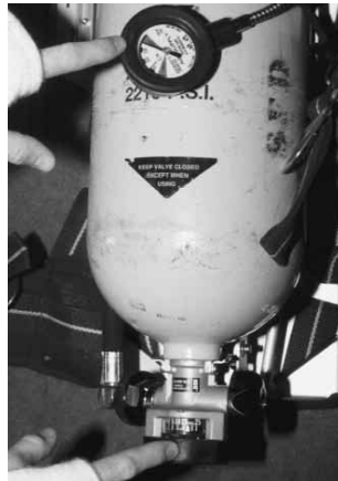
Figura 4.43 La lectura del manómetro de presión del cilindro y la lectura del manómetro remoto deben compararse.
