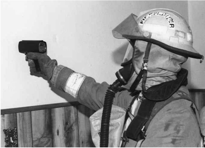
Figura 16.26 Un bombero busca fuegos ocultos con un detector térmico de infrarrojos.
