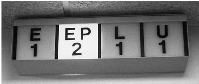
Figura 18.22 Cuadro de señales que muestra a qué unidad se ha avisado para que responda. Gentileza del Cuerpo de bomberos de Phoenix, Arizona (EE.UU.).
