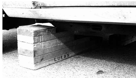
Figura 7.75 Inserte el bloque escalonado de fijación hasta que toque alguna parte del bastidor del vehículo.
