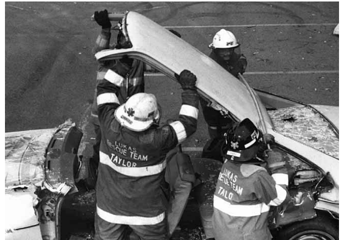
Figura 7.88 Una barra larga situada en el punto por el que se debe doblar el techo facilitará el proceso.
