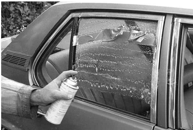
Figura 7.84 El spray adhesivo controla el cristal cuando está roto. Utilice cinta de embalaje con gasas sobre el cristal para formar un asa que le permita retirar el cristal.
