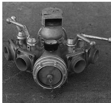
Figura 12.34 Un cuadro de válvulas distribuye agua a varias mangueras.
