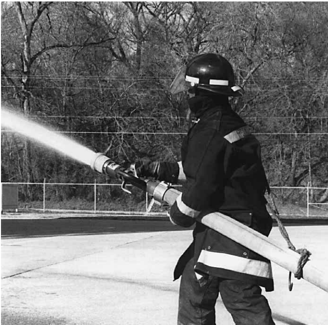
Figura 12.48b Conecte una cuerda en forma de argolla o una correa para mangueras de modo que la boquilla quede al alcance.
