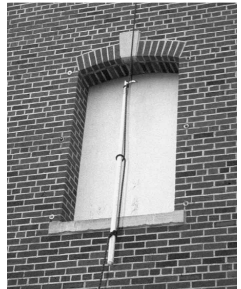
Figura 6.22 Izado de una pértiga con gancho (con la parte superior hacia arriba) utilizando un nudo de ballestrinque al final del mango, un cote en el medio del mango y otro alrededor de la parte superior.
