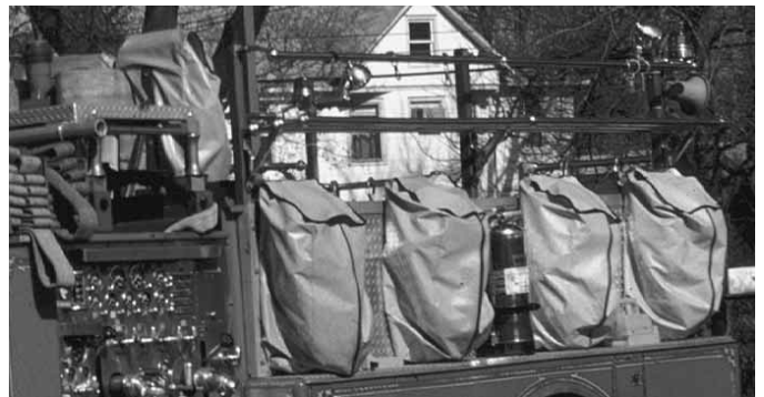
Figura 4.66 Las fundas de lona ayudan a proteger los aparatos de respiración de un exceso de suciedad y humedad. Gentileza de Ron Bogardus.
