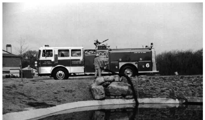
Figura 12.3 La manguera rígida de absorción está diseñada para soportar parte del aspirado de la extracción.
