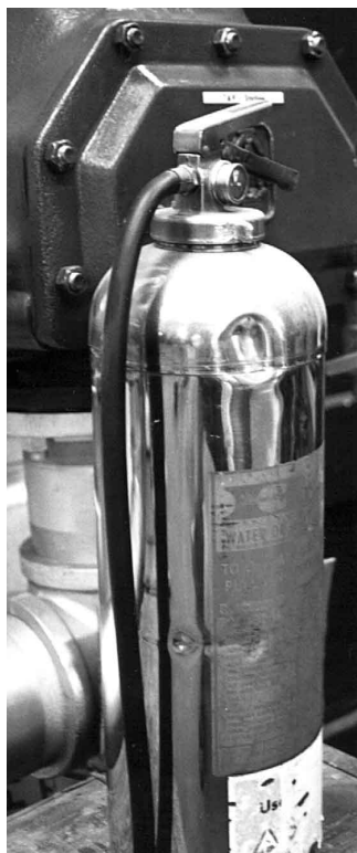
Figura 5.38 Los extintores dañados deben retirarse del servicio hasta que estén reparados y probados.
