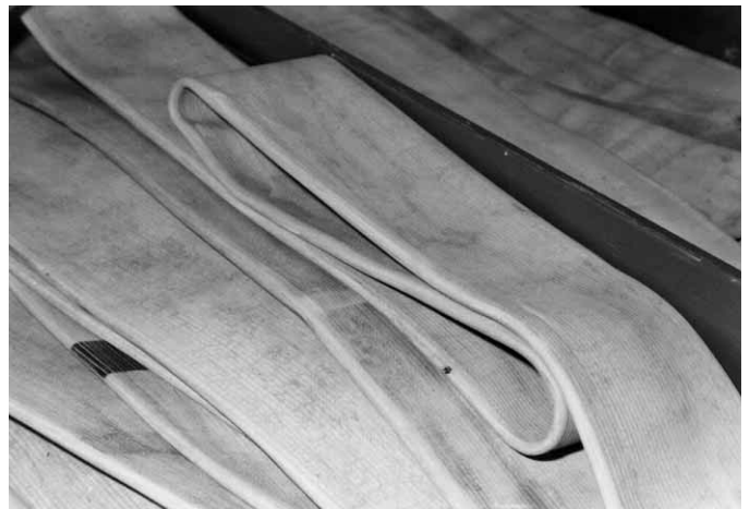
Figura 12.64 Dutchman en una manguera de gran diámetro.
