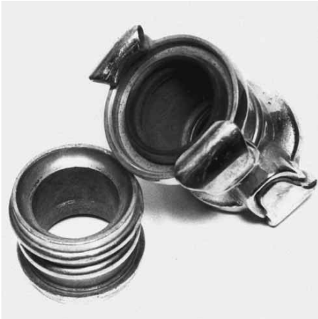
Figura 12.16 Las conexiones de broches se cierran la una a la otra cuando los dos cierres con muelle de la conexión hembra se enganchan a la arandela de la taza de la conexión macho.
