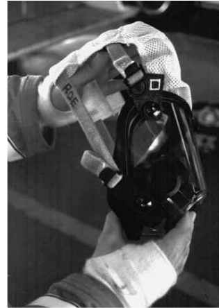
Figura 4.59 El ensamblaje del arnés y las tiras de la máscara deben estar totalmente extendidos.
