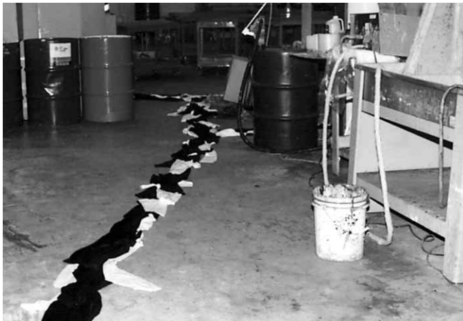
Figura 17.10 Un propagador del fuego se utiliza para propagar el fuego de un punto a otro. Gentileza del Cuerpo de bomberos de Elk Grove Village, Illinois, EE.UU.
