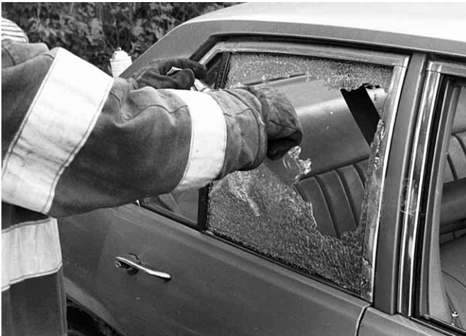
Figura 7.86 Una vez roto el cristal, retírelo cuidadosamente hacia el exterior del vehículo.
