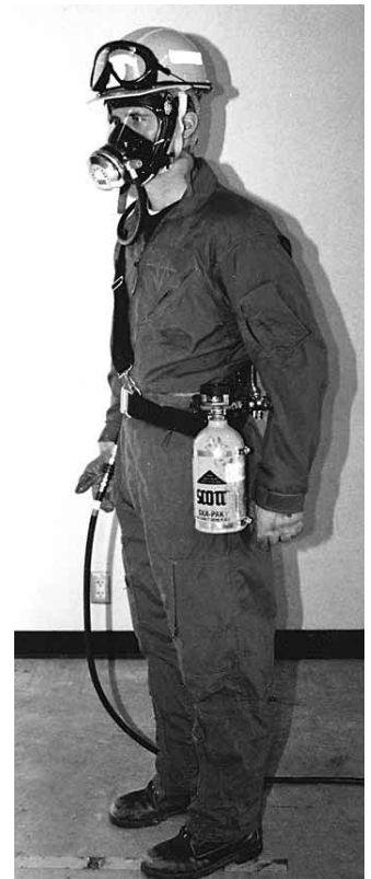
Figura 4.54 El equipo de respiración de línea de aire es útil para las actuaciones de larga duración.
