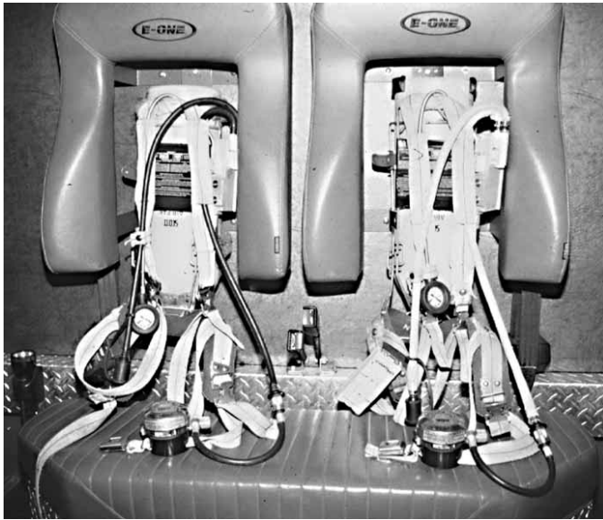
Figura 4.56 Aparatos de respiración montados en un asiento en el vehículo contraincendios.
