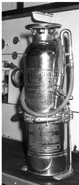
Figura 5.39 Los extintores obsoletos deben retirarse del servicio.
