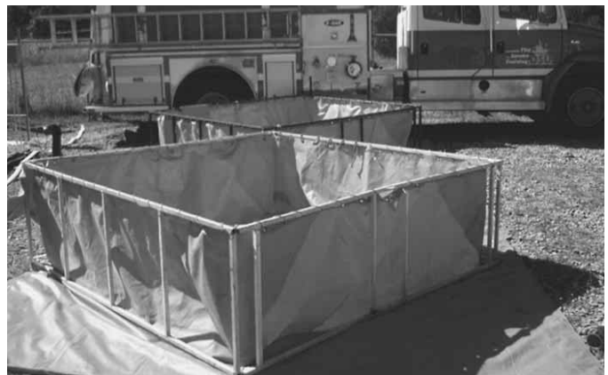
Figura 11.34 Una tela resistente colocada bajo un tanque portátil protege el forro.
