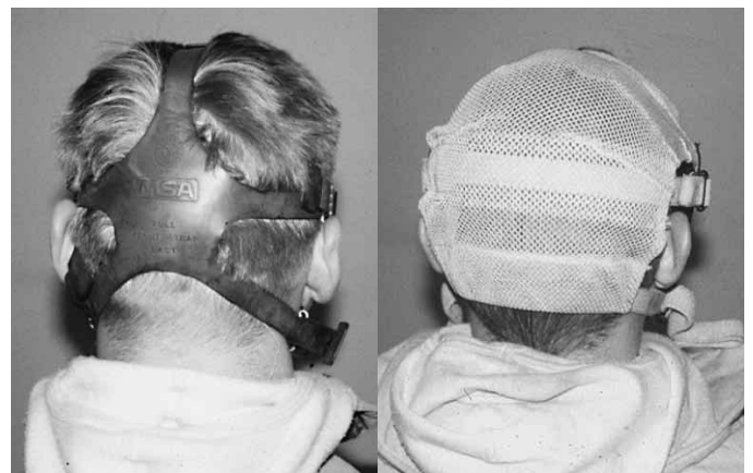
Figura 4.46 Un arnés para la cabeza con tiras ajustables y un modelo de malla o red para el pelo.
