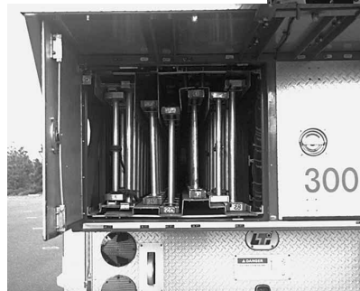
Figura 9.38c Algunas escalas que se montan verticalmente en el lateral del vehículo deben cargarse/descargarse desde detrás.
