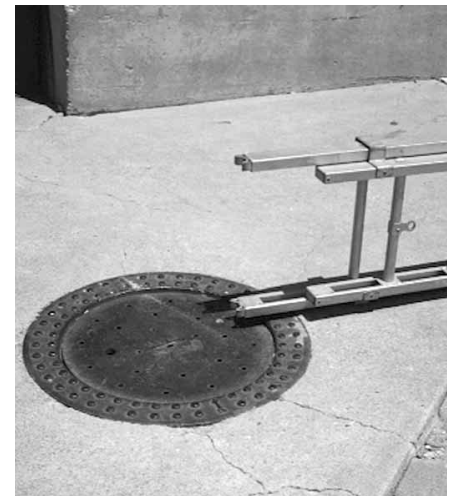
Figura 9.60 Evite colocar las escalas encima de los escotillones, las rejillas y las tapas de los servicios públicos.
