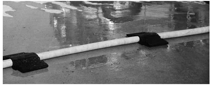
Figura 12.5 Puentes para mangueras en uso.
