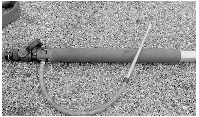
Figura 13.40 Tubo eductor típico para la boquilla de espuma en una línea de mano.
