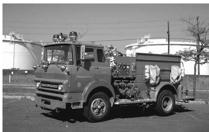
Figura 13.41b Un gran número de vehículos contraincendios industriales están equipados con sistemas de espuma. Gentileza de Ron Jeffers.
