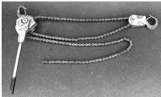
Figura 7.57 Un tipo de polispasto de palanca.
