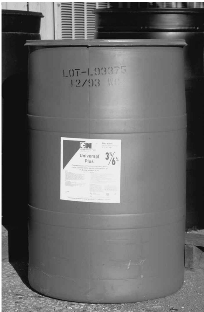
Figura 13.31 Todos los contenedores del concentrado de espuma indican claramente el porcentaje de dosificación en el exterior.
