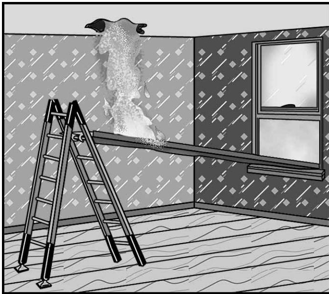
Figura 16.22 Las escalas y las lonas pueden utilizarse para crear canales de agua que permitirán extraer el exceso de agua del edificio.
