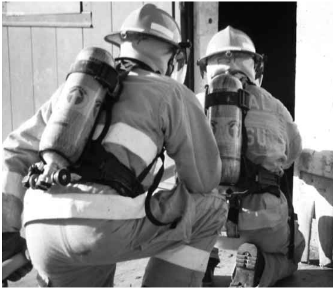
Figura 4.26 Los bomberos siempre deben llevar puesto el aparato de respiración mientras realicen un ataque al fuego.
