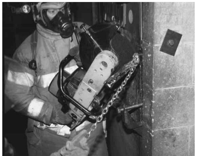
Figura 8.68 Cuando se corta el brazo de un candado con una sierra circular, una segunda persona debe sujetar el candado con la mordaza de presión y la cadena.
