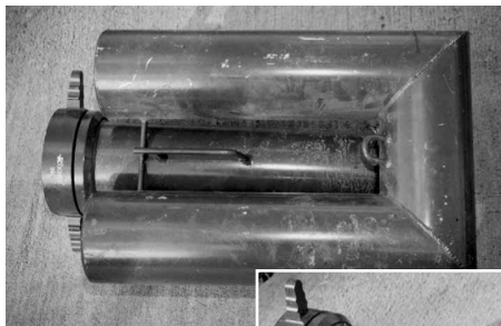
Figura 11.28 El filtro debe tener un mínimo de 600 mm (24 pulgadas) de agua a su alrededor.
