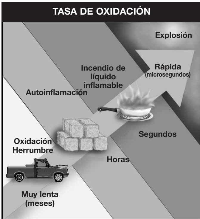
Figura 2.9 La combustión, una reacción química en cadena, puede ser muy lenta o muy rápida.
