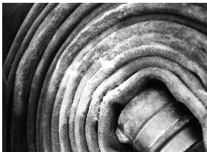
Figura 12.9 El moho puede debilitar el revestimiento de una manguera con recubrimiento textil. Gentileza de Keith Flood.
