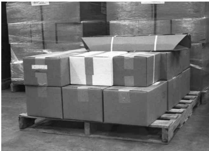
Figura 16.5 Si se colocan las cajas sobre plataformas, quedan protegidas de las pequeñas cantidades de agua que haya en el suelo.
