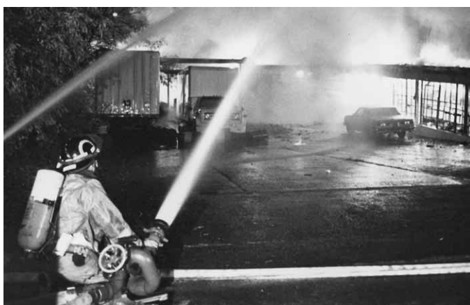
Figura 14.14 Los chorros maestros se utilizan en grandes incendios donde la movilidad no es crucial. Gentileza de Joseph J. Marino.
