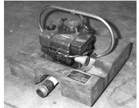
Figura 16.15 Las bombas portátiles pueden utilizarse para extraer el agua de una estructura.
