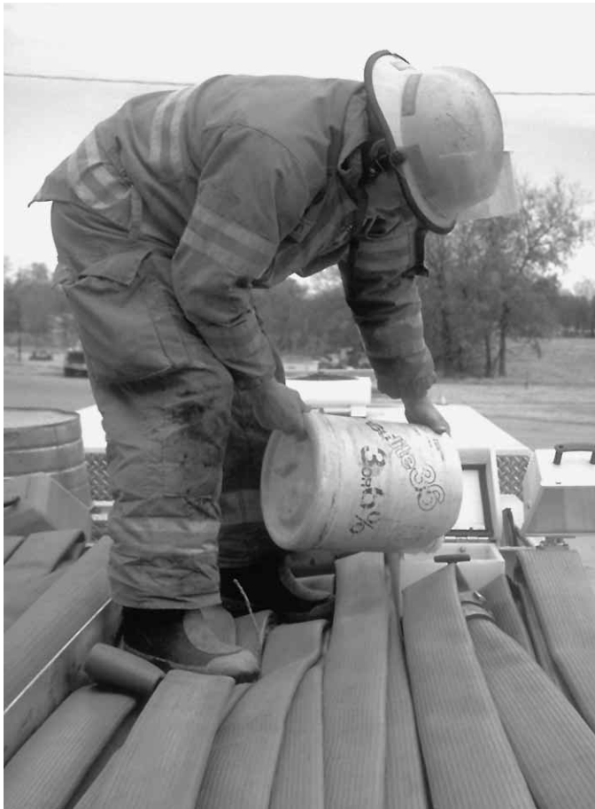
Figura 13.34 La mezcla intermitente puede conseguirse vertiendo concentrado de espuma dentro de la cisterna de agua del vehículo.
