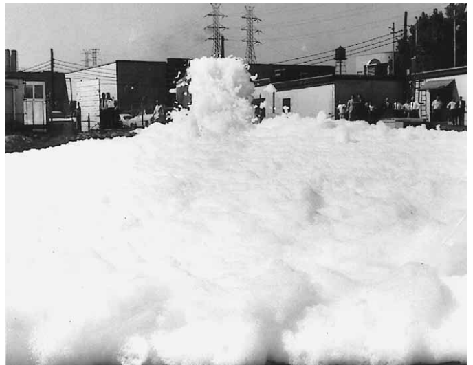
Figura 13.47 Los sopladores mecánicos generan cantidades masivas de espuma de expansión alta. Gentileza de Walter Kidde, Inc.
