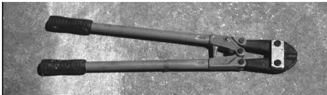
Figura 8.8 Las tijeras cortapernos son excelentes para cortar cadenas, barras de hierro, cables y otros materiales sin reforzar.
