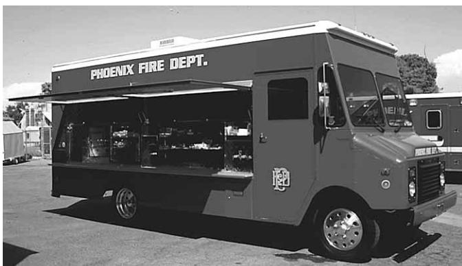
Figura 1.18 Las unidades de avituallamiento proporcionan comida y bebida en los incidentes de larga duración.
