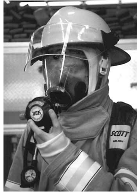
Figura 4.39 Este regulador se conecta directamente a la máscara.
