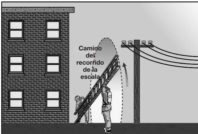
Figura 9.68 Los cables aéreos se esquivan si se utiliza un levantamiento en paralelo.
