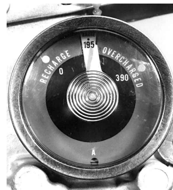
Figura 5.4 Manómetro de presión que muestra claramente el rango de actuación.
