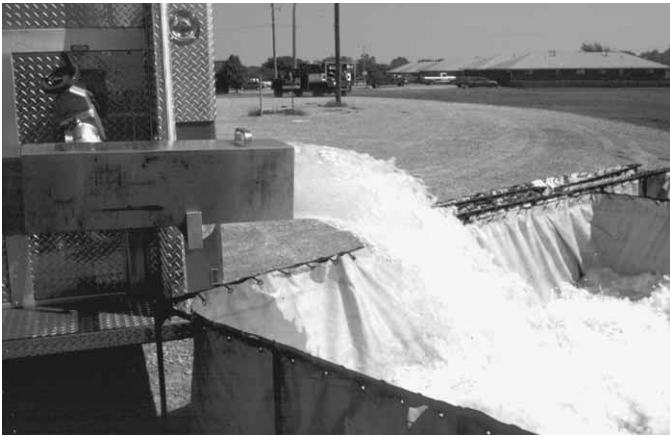
Figura 11.35 Las válvulas de vaciado proporcionan la capacidad máxima de descarga. Aunque pueden estar en cualquier lado del vehículo, suelen colocarse en la parte trasera. Gentileza de Mike Wieder.
