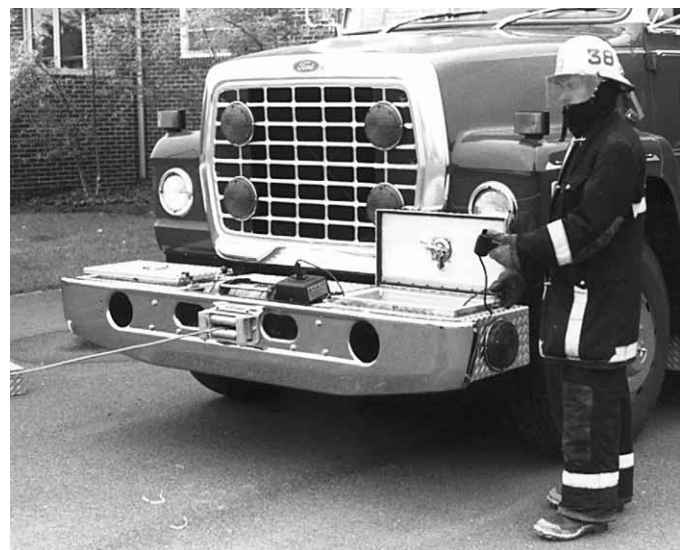
Figura 7.55 El operario de cabrestante utiliza el dispositivo de control remoto.
