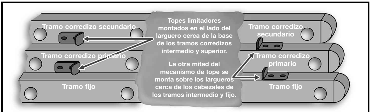
Figura 9.15 Tipos de topes limitadores habituales para escalas de extensión y escalas de extensión con puntales estabilizadores.
