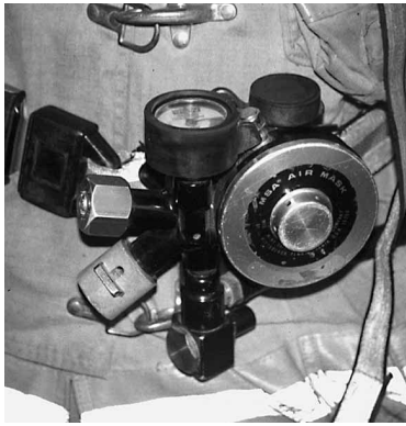
Figura 4.38 El regulador controla el flujo de aire para satisfacer los requisitos respiratorios del usuario.
