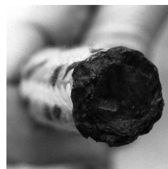
Figura 6.5 La punta quemada de la cuerda de trenzado doble.
