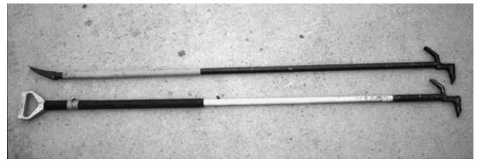
Figura 8.13b El abridor para techos de metal (arriba) es un gancho totalmente metálico diseñado para realizar tareas pesadas de palanca y estiramiento. El gancho multiusos (abajo) tiene un mango de madera que no puede soportar el mismo tipo de uso.
