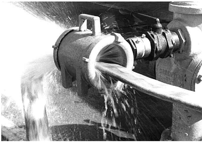
Figura 12.12 Una lavadora a presión limpia el recubrimiento de la manguera con un chorro de agua de mucha presión que rodea la manguera.
