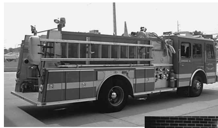
Figura 9.38b Estas escalas se cargan en posición plana desde detrás del aparato.
