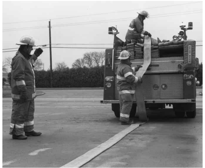
Figura 12.61 Se puede acomodar una manguera de gran diámetro montándola directamente en el vehículo y conduciendo lentamente hacia atrás a medida que se acomoda la manguera en la cama.
