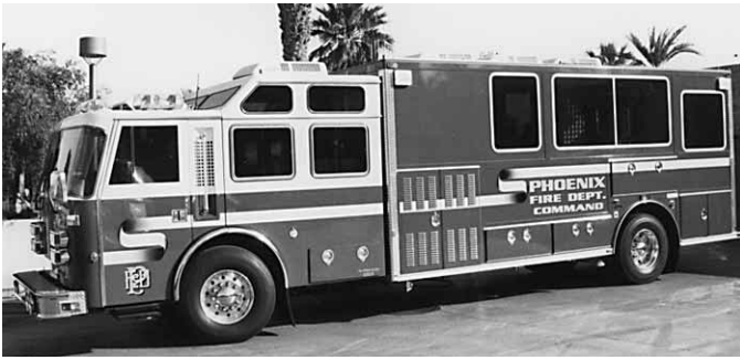
Figura 18.30 Este puesto de mando móvil y vehículo de comunicaciones puede utilizarse en incidentes grandes.
