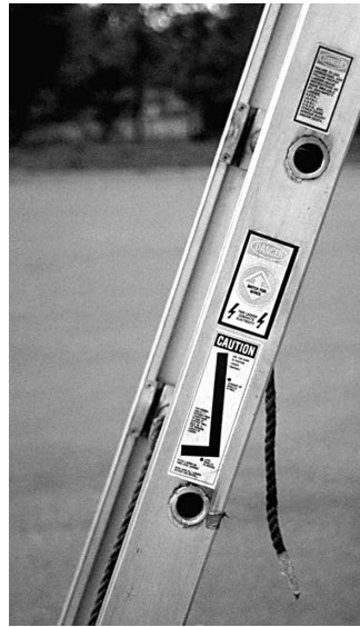
Figura 9.64 Las escalas más nuevas tienen etiquetas que ayudan a los bomberos para obtener un ángulo de subida adecuado.
