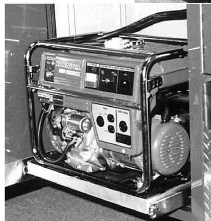
Figura 7.27 Generador montado en un vehículo.
