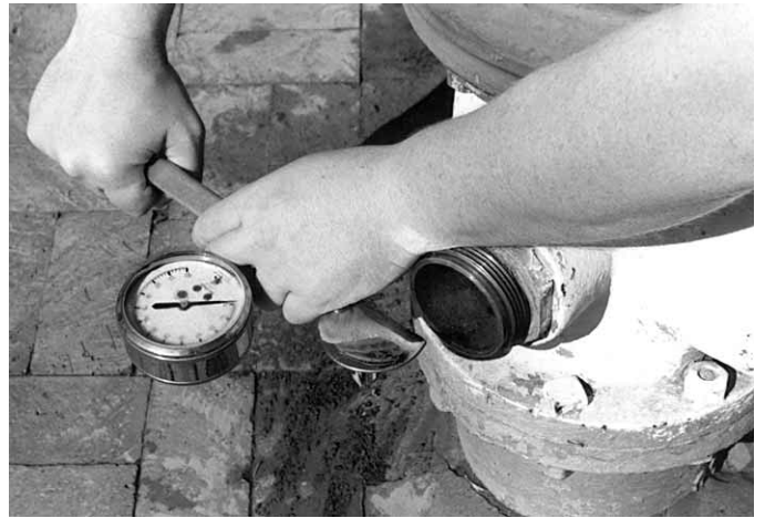
Figura 11.25 Establece el tubo de Pitot apoyando la parte izquierda del puño contra el orificio de descarga. A continuación, deslice la hoja en el chorro.
