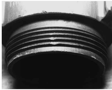
Figura 12.4 Daño típico en las roscas de las mangueras.
