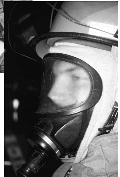
Figura 4.50 Hay que probar la válvula de exhalación antes de entrar en una atmósfera peligrosa.
