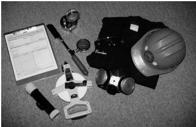
Figura 19.13 El equipo que aparece en la fotografía puede ser necesario en el lugar donde se lleva a cabo la inspección de prevención de incendios.
