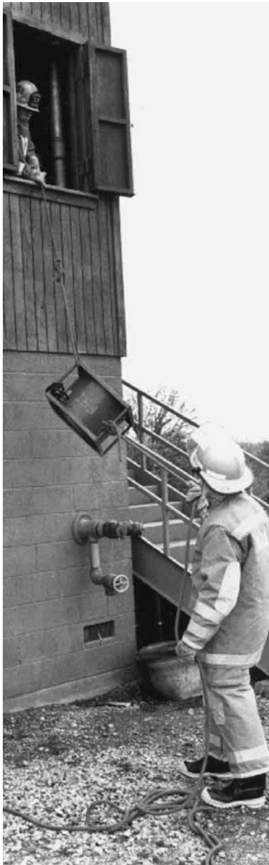
Figura 6.24 Utilice un nudo de ocho de unión o un as de guía para izar un extractor portátil. Observe que el cable de cola evita que el extractor choque contra el edificio.
