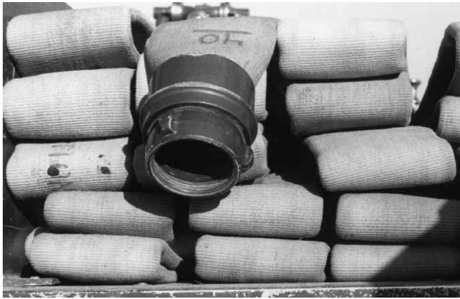
Figura 12.74 En un tendido hacia el incendio, la conexión hembra sale primera.
