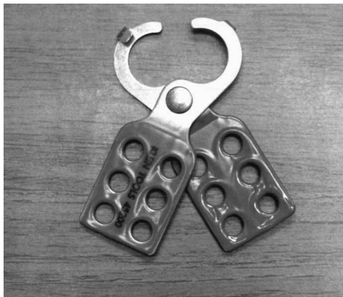
Figura 14.39 Utilice los dispositivos de cierre y marcado en el equipo eléctrico sin carga. El uso de estos dispositivos reduce la posibilidad de que alguien encienda la corriente mientras se repara el equipo. Gentileza de Jim Hanson.
