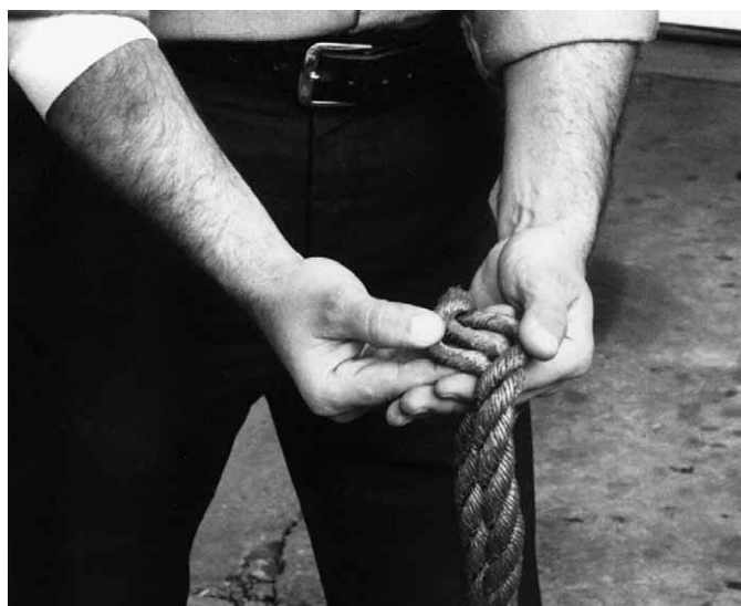
Figura 6.4 Inspeccione la cuerda torcida desenrollando las secciones.
