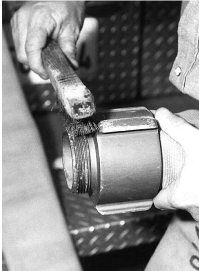
Figura 12.24 Utilice un cepillo de alambre para limpiar las roscas de la conexión macho con materiales extraños.
