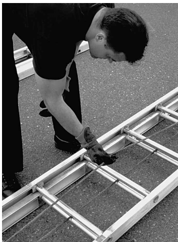
Figura 9.30 Inspeccione la cuerda por si está deteriorada o tiene cortes.
