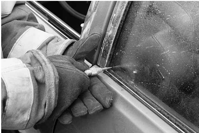
Figura 7.83 Observe la posición de la mano del rescador que utiliza el graneador cargado por resorte. Pone la mano izquierda de manera que evita que la derecha atraviese la ventana mientras se rompe el cristal.
