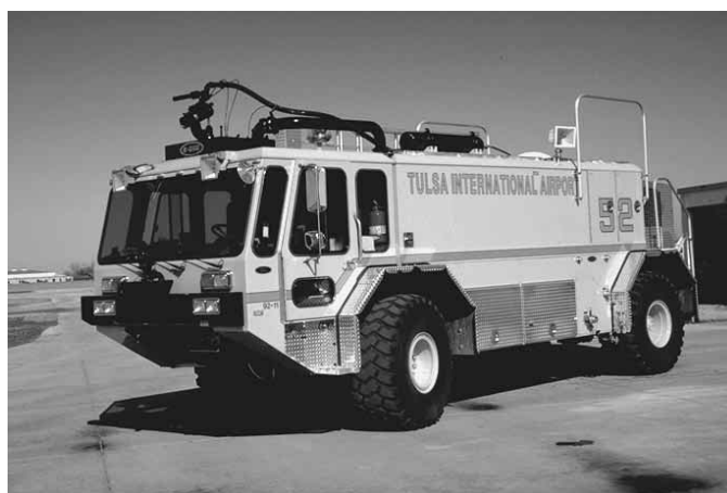
Figura 13.41c Prácticamente todos los vehículos de ARFF están equipados con sistemas de espuma grandes.
