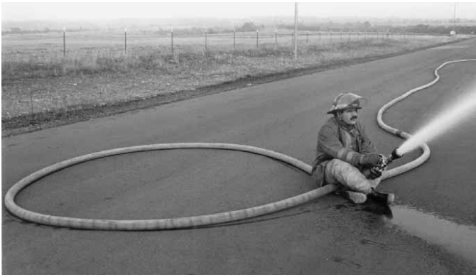
Figura 12.94 Si se hace una gaza en una manguera de 65 mm (2,5 pulgadas), un solo bombero puede hacerla funcionar.
