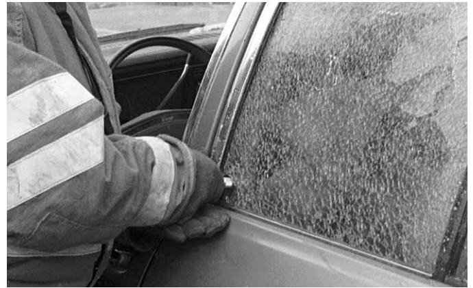
Figura 7.85 Cuando se rompe el cristal, el adhesivo lo retiene formando una hoja.
