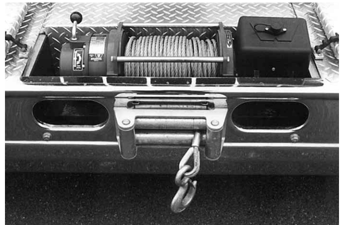
Figura 7.54 Cabrestante montado en un vehículo.
