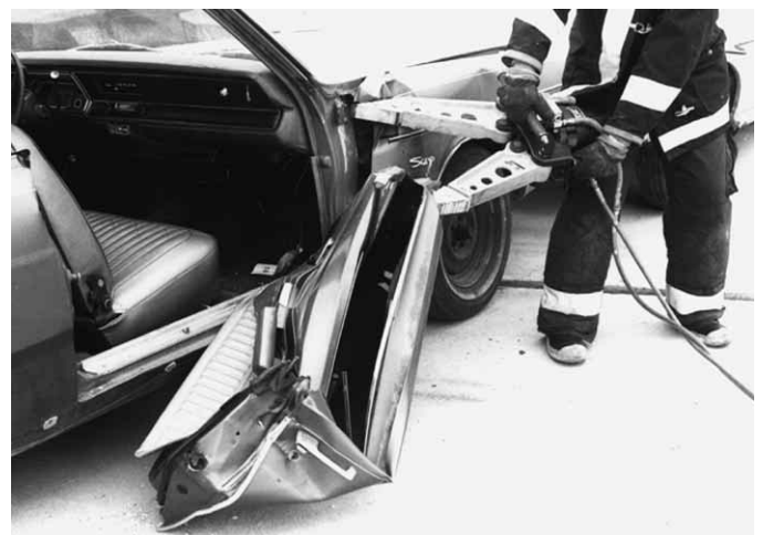
Figura 7.89 Cuando la bisagra inferior se rompe, esta parte de la puerta debe quedar libre.
