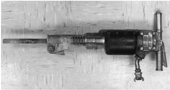
Figura 8.85 El martillo neumático es una herramienta de tareas pesadas para atravesar muros de mampostería.
