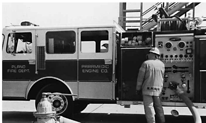
Figura 12.2 Una manguera blanda transporta agua desde el hidrante a la toma de la bomba.
