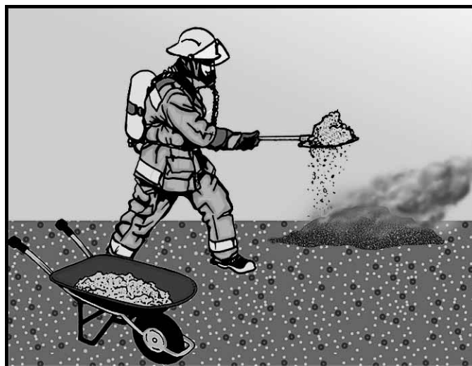
Figura 5.23 Se puede echar agente de clase D sobre el incendio con una pala.
