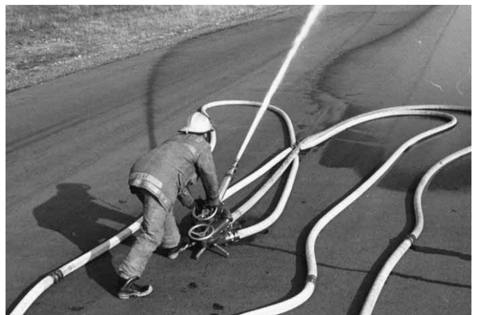
Figura 14.17 Una persona puede manipular el dispositivo de chorro maestro.
