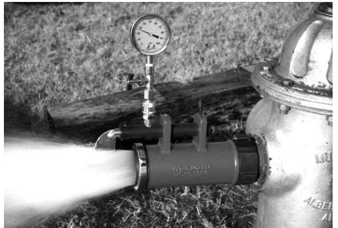
Figura 11.26 Tubo de Pitot fijo.
