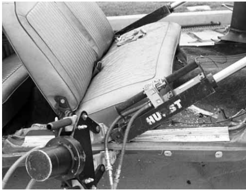
Figura 7.91 Se puede insertar un pilar en los cortes de desbloqueo para sostener el salpicadero mientras se retiran los arietes de extensión.
