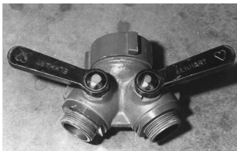
Figura 12.30 Conexión "Y" común con entrada de 65 mm (2,5 pulgadas) y dos salidas de 38 mm (1,5 pulgadas). A menudo se llama cople "Y" de la línea directora.
