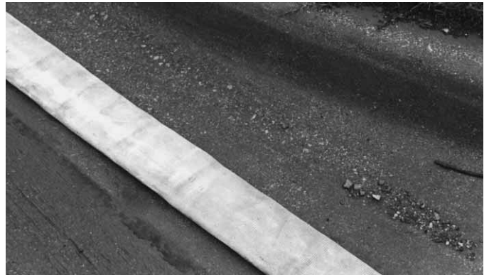
Figura 12.10 Evite tender la manguera sobre desagües que la expondrían a basura y escapes.
