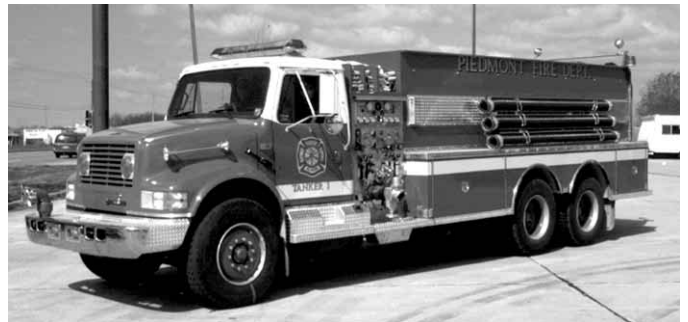
Figura 11.31 Algunos camiones cisterna tienen grandes bombas y llevan un equipo similar al de las compañías de motores normales. Gentileza de Mike Wieder.
