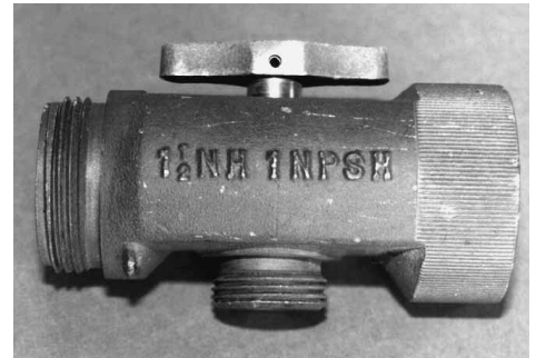
Figura 12.33b Ladrón de agua forestal diseñado para acoplar una manguera de 25 mm (1 pulgada) a la manguera principal de 38 mm (1,5 pulgadas).
