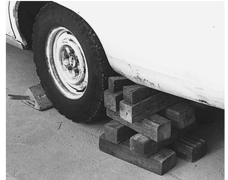
Figura 7.75 Inserte el bloque escalonado de fijación hasta que toque alguna parte del bastidor del vehículo.
