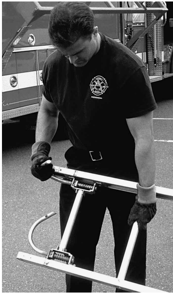
Figura 9.29 Los ganchos de la escalera de ganchos deben poder abrirse con facilidad.
