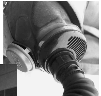
Figura 4.49 La válvula de exhalación es una válvula sencilla, de una sola dirección, que libera el aire exhalado sin dejar entrar la atmósfera exterior contaminada.
