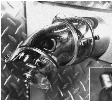
Figura 12.38b Tapa utilizada para cerrar conexiones macho o descargas de la bomba.
