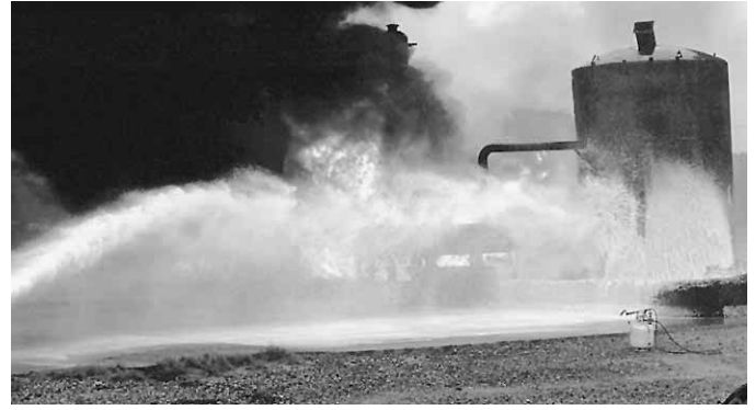
Figura 13.51 Aplicación de espuma mediante el método de lluvia.
