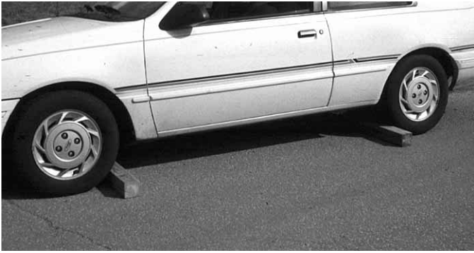
Figura 7.71 Cuando un vehículo está a nivel del suelo, bloquee las ruedas en ambas direcciones.
