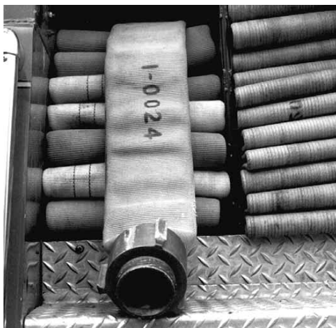
Figura 12.77 Prepare camas de mangueras para tendidos hacia el abastecimiento de agua de forma que la primera conexión que salga de la cama sea macho.
