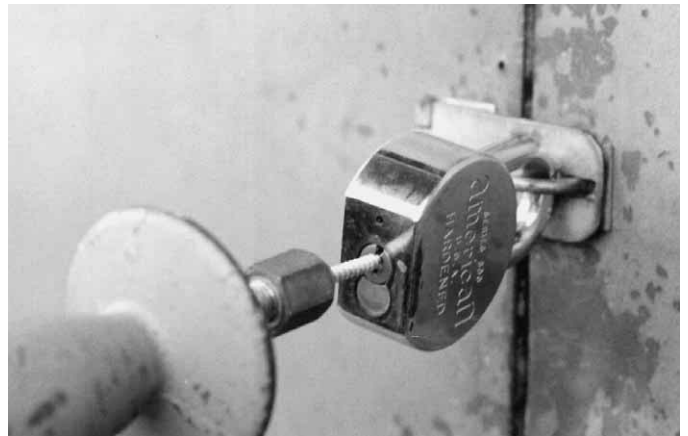
Figura 8.67 Atornille la punta metálica reforzada del tornillo utilizando el destornillador de cerrajero al menos 19 mm (0,75 pulgadas) en la ranura de la llave y manténgala en posición recta para evitar que se rompa el tornillo.
