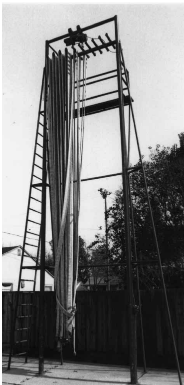
Figura 12.7 Las torres para mangueras están diseñadas para colgar las mangueras y secarlas de forma adecuada.
