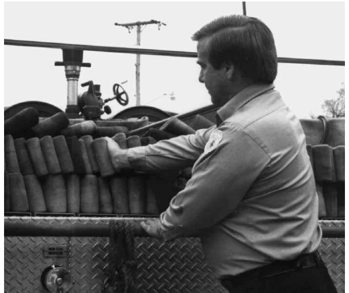
Figura 12.57 Si la manguera se ha acomodado de forma adecuada, el bombero debe poder introducir la mano entre los pliegues.
