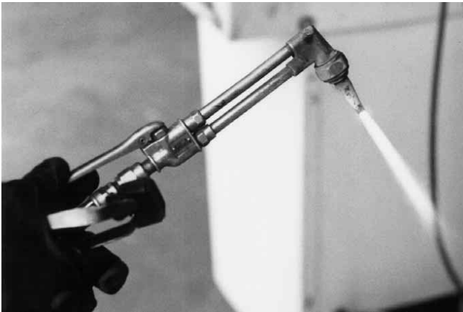
Figura 8.9 Los sopletes de corte son eficaces para cortar metales demasiado gruesos para utilizar una sierra.
