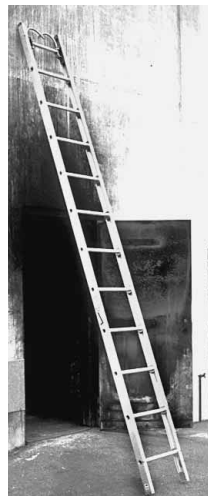
Figura 9.59 No coloque las escalas delante de puertas.
