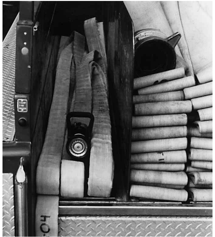
Figura 12.54 Las camas para mangueras tienen paredes divisorias para separar los diferentes acomodos.
