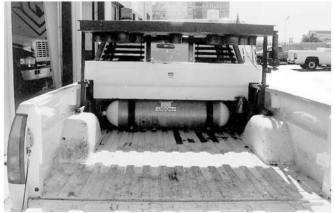
Figura 14.54 Algunos vehículos utilizan gas comprimido como combustible en vez de combustibles líquidos.
