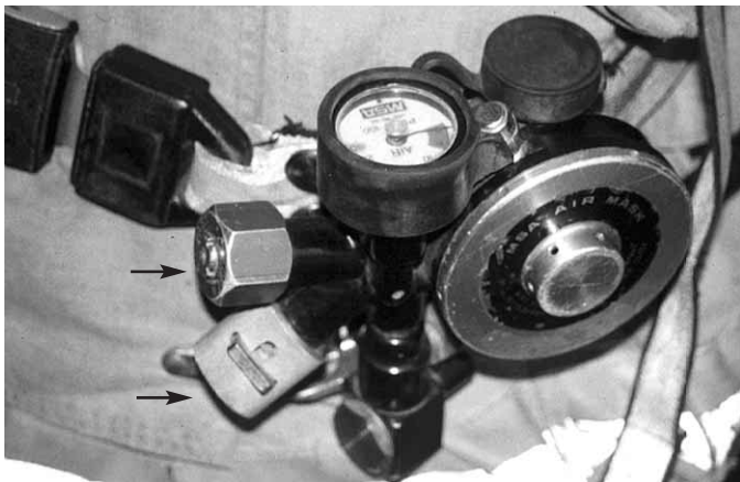
Figura 4.40 La válvula de línea principal (abajo) y la válvula de paso directo (arriba).
