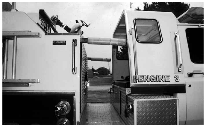
Figura 1.32 Las barras de seguridad proporcionan una protección limitada a los ocupantes de la zona de asientos de salto.
