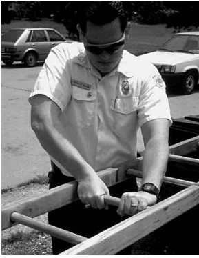
Figura 9.28 Inspeccione los peldaños para asegurarse de que están ajustados.
