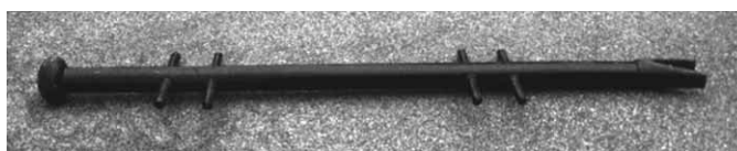
Figura 8.82 Se puede utilizar este ariete para agujerear los muros de mampostería.
