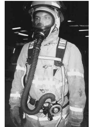
Figura 4.45 Esta manguera de baja presión conduce el aire del regulador a la máscara.
