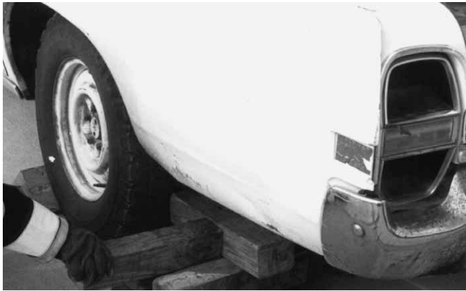
Figura 7.76a Empuje la parte posterior del pilar de caja hasta su lugar con otro pilar para evitar tener que trabajar debajo del vehículo.
