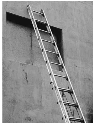
Figura 9.56 Sitúe la escala directamente encima de la abertura de modo que el chorro de la manguera se pueda descargar dentro de la ventana.
