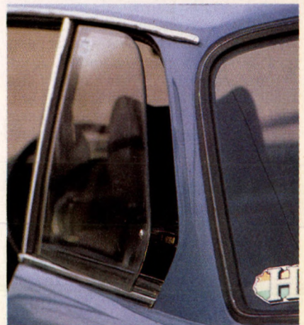
Középosztálybeli kétajtós modell lévén természetes volt, hogy buktható a hátsó ablak. Jelentősen javította a szellőzést
