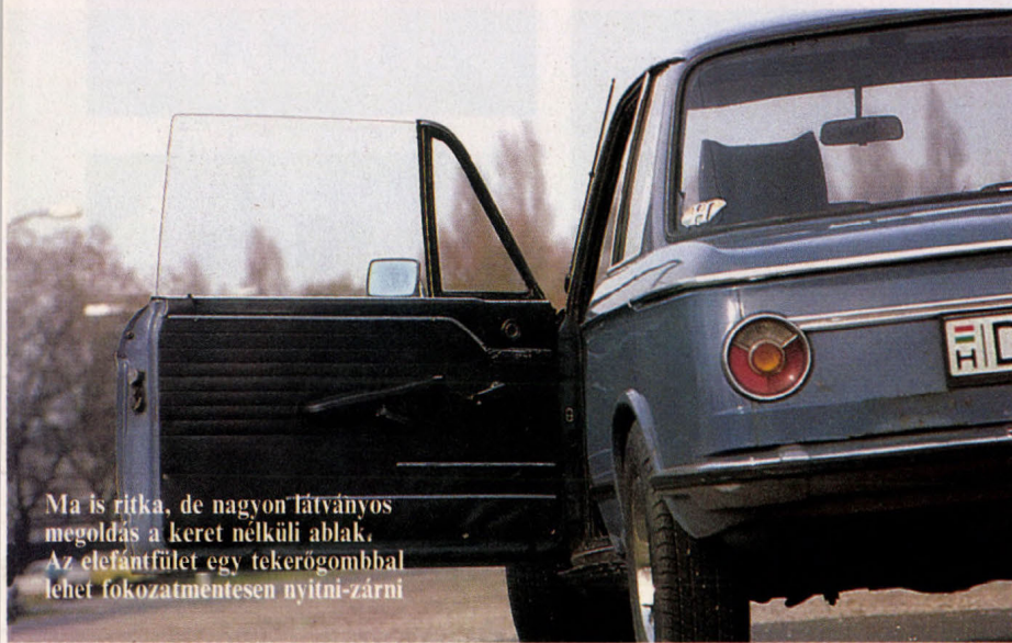
Sajátos a két kör alakú hátsó lámpatest. ésőbbi modelleken szögletesre változott
