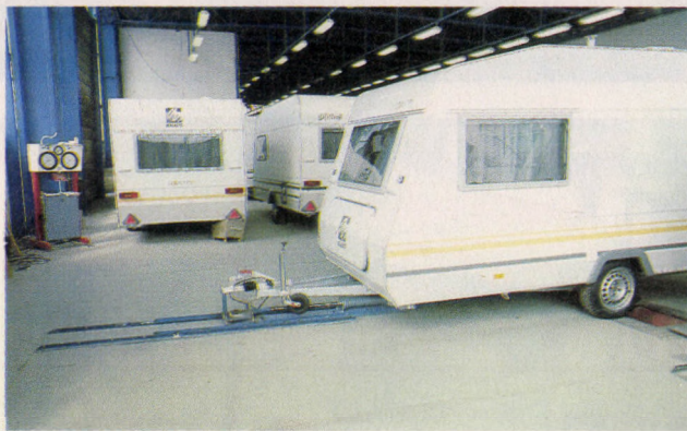
Az összeszerelés után a kocsinak még ki kell állnia a fékpadi próbát is
