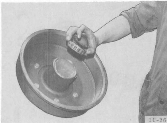
28. Lagerinnenring mit Rollen käfig des inneren Kegelrollenlagers eingefettet einlegen.
