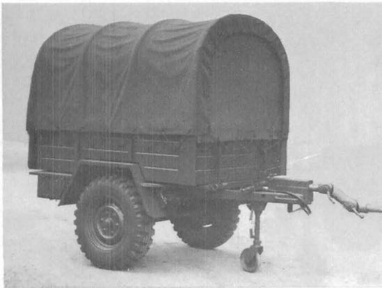
Bild 31 Arbeitsanhänger mit Pritsche und Plane
