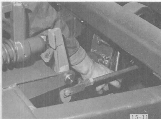
16. Stützrad aus der Falle ausklinken und abklappen (Hebel zum Körper hinziehen).
