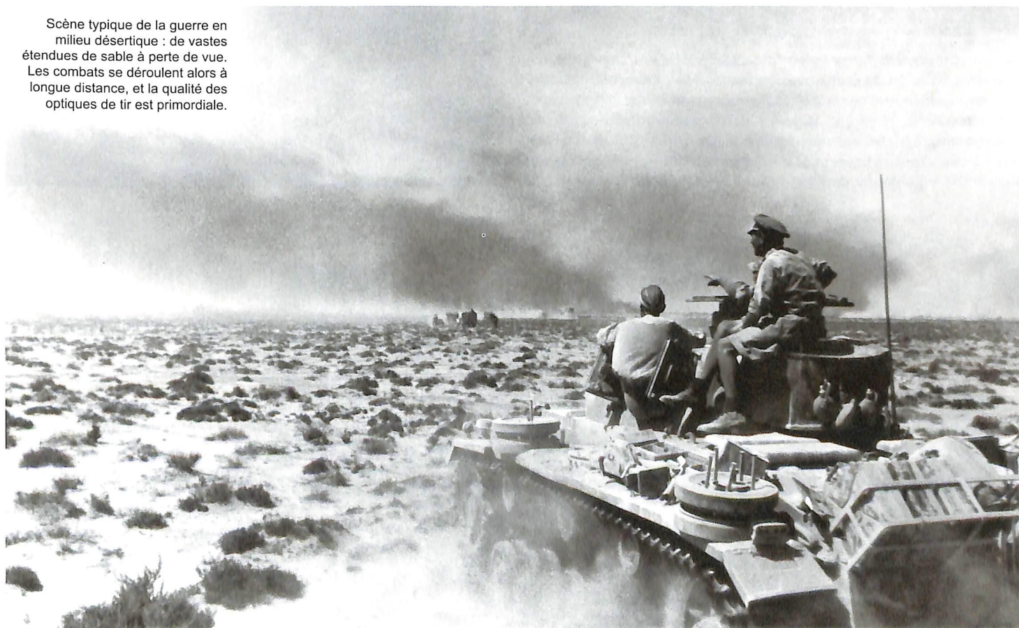
▲ Un Panzer III à canon court bardé de patins de chenilles. Censés renforcer la protection face aux canons anglais, ils grèvent surtout les performances du châssis et accélèrent l'usure des éléments mécaniques, qui n'ont pas vraiment besoin de cela dans un environnement qui les sollicite déjà beaucoup. ECPA-D
