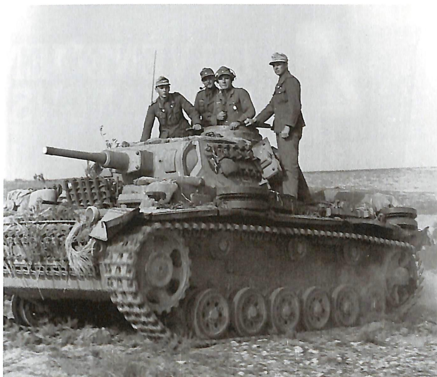
▲ Un Panzer III à canon court bardé de patins de chenilles. Censés renforcer la protection face aux canons anglais, ils grèvent surtout les performances du châssis et accélèrent l'usure des éléments mécaniques, qui n'ont pas vraiment besoin de cela dans un environnement qui les sollicite déjà beaucoup. ECPA-D
