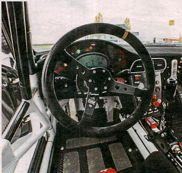
Handlungskammer: Alles legal, die 7 steht für den Rückwärtsgang
