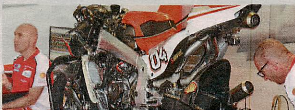
Ducati D16 GP14.2: Rahmen und Tank schlanker, Motor gekippt
