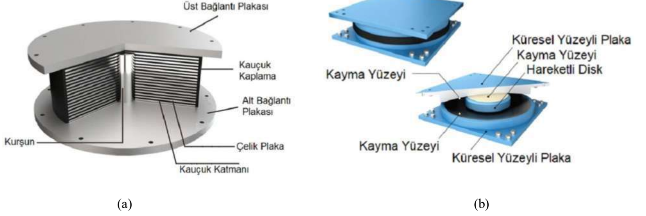
Şekil 2: (a) Kauçuk esaslı izolatör kesiti[4], (b) kayma esaslı izolatör kesiti[5]
