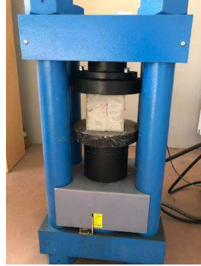
(b) Örnek beton basınç testi
