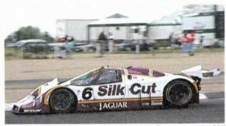
ル・マン仕様のジャガー-XRJMLM。低いウイングと露出したリヤタイヤが特徴
