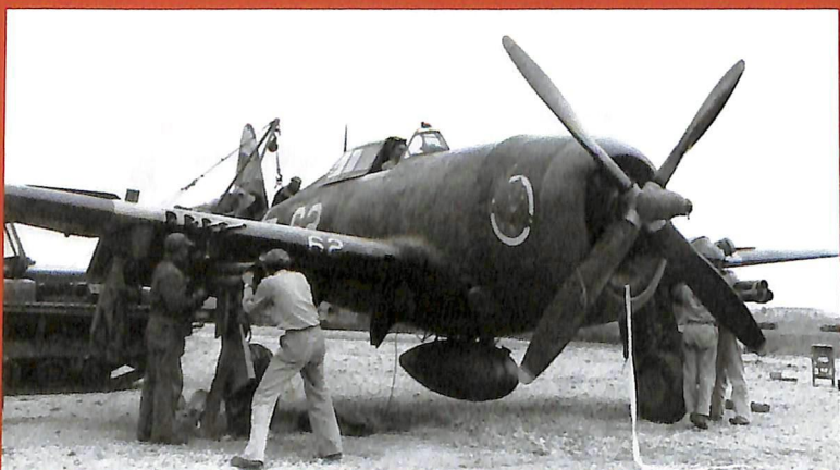
▲ Un P-47D du 65th Fighter Squadron, 59th Fighter Group, est en train d'être armé de tubes lance-roquettes de 127 mm sur le terrain d'aviation d'Alto en Corse. US Nara
