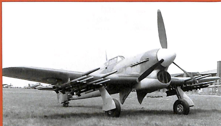
▲ Ce cliché montre le premier Typhoon à être équipé de roquettes, photographié pendant les essais officiels à l'A&AEE de Boscombe Down, en août 1943. Collection C. Thomas
