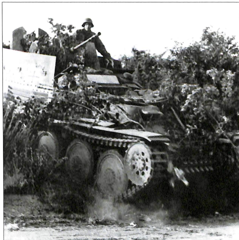
◀ Le Flakpanzer 38(t) Ausf. L (Sd.Kfz. 140) reprend le châssis du char léger Panzer 38(t) . L'armement est constitué d'un canon de 2cm Flak 38 , installé sur la partie arrière. Cette pièce manque de puissance de feu pour parvenir à réellement inquiéter les pilotes des avions d'assaut adverses. Toutefois, 141 exemplaires seront assemblés, car la conversion est relativement aisée et surtout peu coûteuse. Droits réservés
