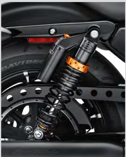
B. SCREAMIN' EAGLE VOLLSTÄNDIG EINSTELLBARE PIGGYBACK STOSSDÄMPFER
