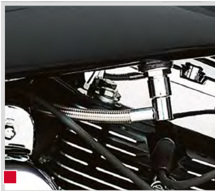
E. EDELSTAHLUMMANTELTE EFI KRAFTSTOFFLEITUNG
