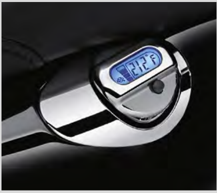
D. PEILSTAB FÜR ÖLSTAND UND ÖLTEMPERATUR MIT BELEUCHTETER LCD-ANZEIGE – CHROM
