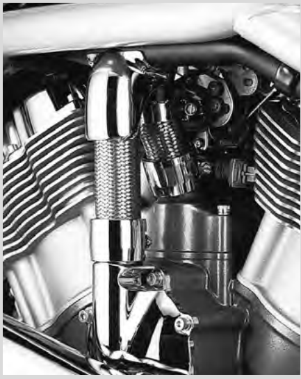
E. EDELSTAHLUMMANTELTE KÜHLMITTELEITUNG
