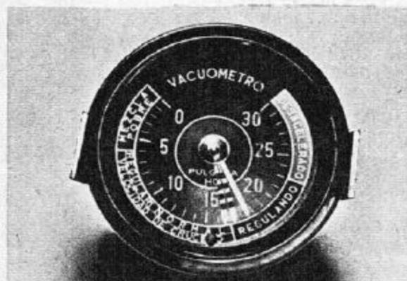
Para averiguar si las bujías están deficientes hay que desconectar una por vez. En los motores de cuatro cilindros, al desconectar una bujía la aguja cae de 1 1/2 a 2 pulgadas. En los de seis cilindros la caída es de 3/4 a 1 1/2 pulgadas. Si al desconectar la bujía no se produce ninguna caída, significa que ésta no funciona o bien que hay un corte de corriente, aunque también puede ser que una válvula de escape esté quemada.
