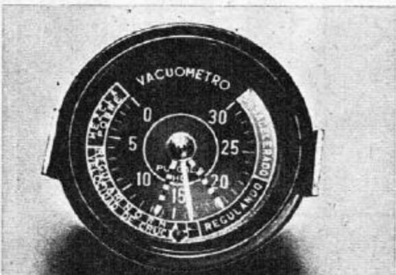
Si la aguja oscila entre las 15 y 18 pulgadas significa que la mezcla es demasiado pobre. Si las toberas del carburador y el instrumento están bien colocados, busque una pérdida de aire en el carburador o bien en el caño del múltiple de admisión. También puede ser ocasionada por desperfecto del carburador, como ser bujes de los movimientos desgastados por los que se introduce aire por demás.
