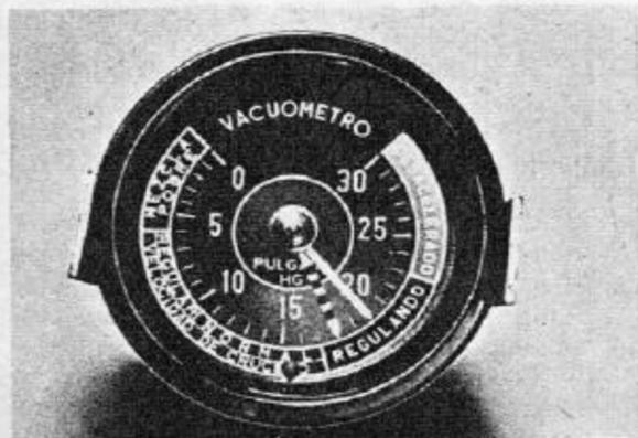
Si la aguja marca un vacío normal pero tiene un ocasional golpeteo, es probable que la dificultad se encuentre en el sistema de ignición. Revise las bujías y también chequee la llave de contacto. Si el motor ratea, los resortes del avance en el distribuidor pueden estar sueltos. No conviene usar por más de 15.000 km los mismos bujías. Cada 5.000 km es aconsejable ajustar la luz de los electrodos. Casi siempre las fallas de este tipo se deben a las bujías.
