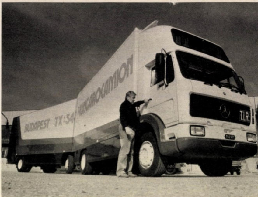
A Hungarocamion új csodája a 18 méter hosszú, csuklós szerkezetű ruha-, illetve bútorszállítója. Európa első ilyen jellegű szállítójárműve, amelyet Mercedes alvázra épített a nyugatnémet Ackermann-cég. A légrugós jármű két rakodóegysége berakodáskor egybenyitható. A jó vonalvezetésű szerelvény 10 százalék üzemanyaggal fogyaszt kevesebbet hasonló társainál
