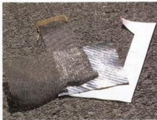
アルミハニカム、カーボン繊維などでしっかりと製作してある
