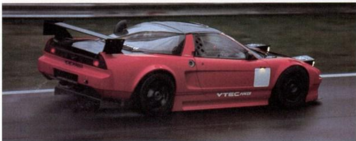
94年型モディファイ車にもオーバーフェンダーが付けられているが、フロントにはルーバーが見える。また煙突状のエアスクープは、テスト専用のもの
