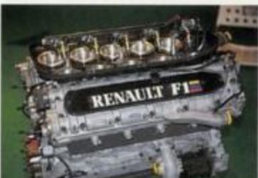
3.1化によって、いっそうの高回転化が図られたルノーRS7。今年最強のエンジンか?
