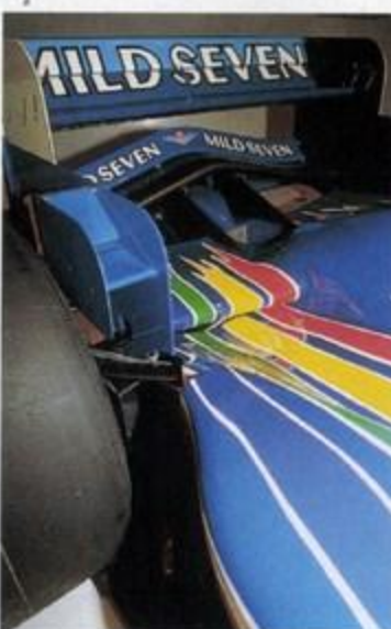
空力を考えて、リヤサスペンションのアップパーアームはウイング形状のカウルでカバーされた
