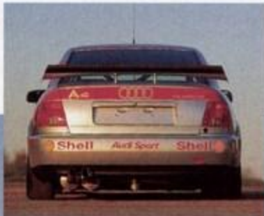
リヤウインドウのRに合わせたウィング形状が特徴的だ
