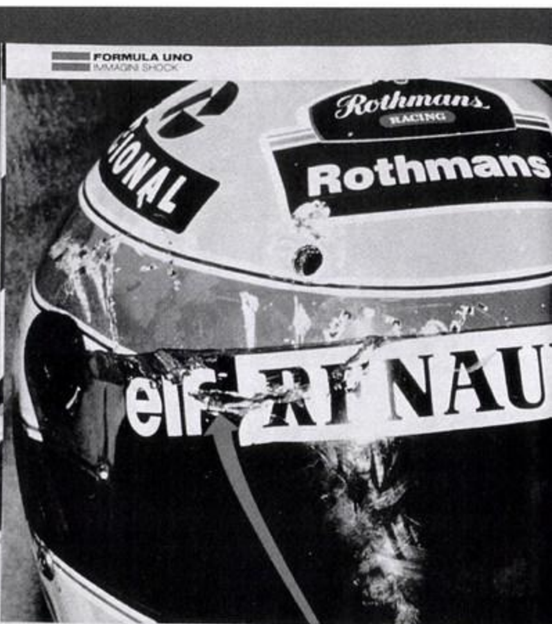
Ecco il punto in cui il braccio della sospensione anteriore ha sfondato la visiera del casco di Ayrton: si tratta di una lacerazione che all'inizio non era stata nemmeno notata. Ha esattamente le dimensioni del ferro acuminato che lo ha colpito. La calotta, invece, ha resistito perfettamente anche all'impatto della ruota che l'ha sfiorata e avrebbe retto anche al colpo della sospensione...
