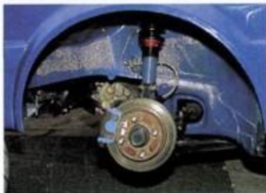
フロントの足まわり。超小型のブレーキローターが見える。ショックなどはほとんどがニスモ製
