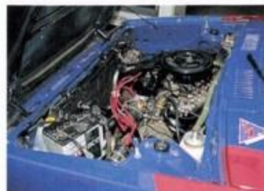
キャブ仕様のMA10Sが横置きされるエンジンルーム。小型バッテリーで軽量化を図っている
