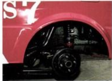
リアの足まわりをのぞくとブレーキローターがないのに驚くが、これはドラム式のブレーキのため
