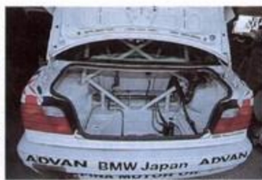
ロールケージはダンパーピボットに直付け
