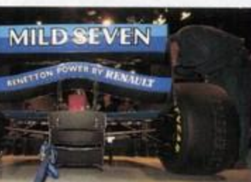
後方から見たリヤセクション。カバーされたリヤアップパーアームが、この写真でも確認できる
