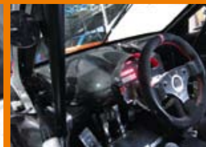
Légátvezető csatorna a műszerfal alatt és a bal oldali ajtón, hogy a túlnyomás és a hő minél egyszerűbben távozhasson a motortérből
