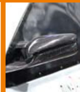
Visszapillantó tükrök, amelyet egyetlen más kocsin sem láthatunk. Céljuk a légellenállás csökkentése, súlyuk darabonként 76 gramm
