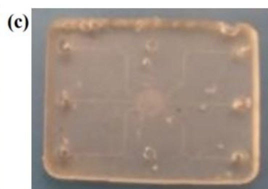
Máscaras para otro de los primeros prototipos del chip microfluídico.
