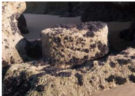
Areniscas talladas para la extracción de rodillos para molienda
