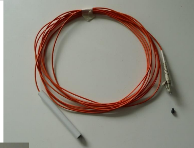
Glasvezel 50 \mu\text{m} Multi Mode Patch kabel met micro lenzen
