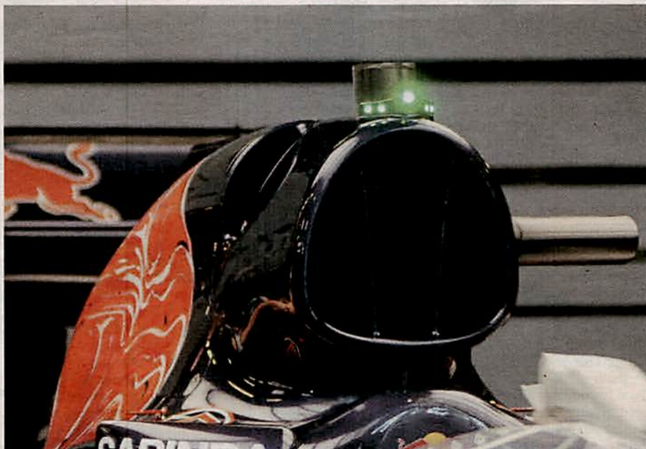
Toro Rosso hat unter der Haube aufgeräumt: Neu sind zwei zusätzliche Lufteinlässe an der Airbox
