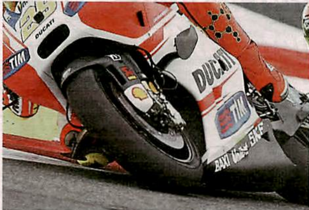
Ducati: Flügel stehen bei Schräglage parallel zum Boden
