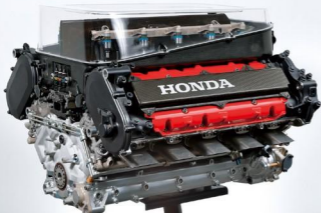
006に搭載されたHonda RA004E。塚野は前半戦このエンジンのトラブルに苦しめられたが、信頼性は高く、ライバルと比較しても軽量化ではないながら、パワフルなユニットであった。
