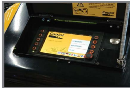
El panel de control cuenta con un gran display para la configuración de la hidrodemolición avanzada, encendido y acelerado del motor.
