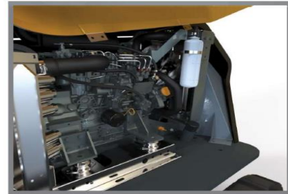
El área de servicio al motor es completamente accesible al abrir la trampilla del lado izquierdo
