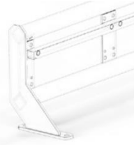
La extensión de la viga de alimentación está disponible para aumentar 350 mm el ancho del corte.
