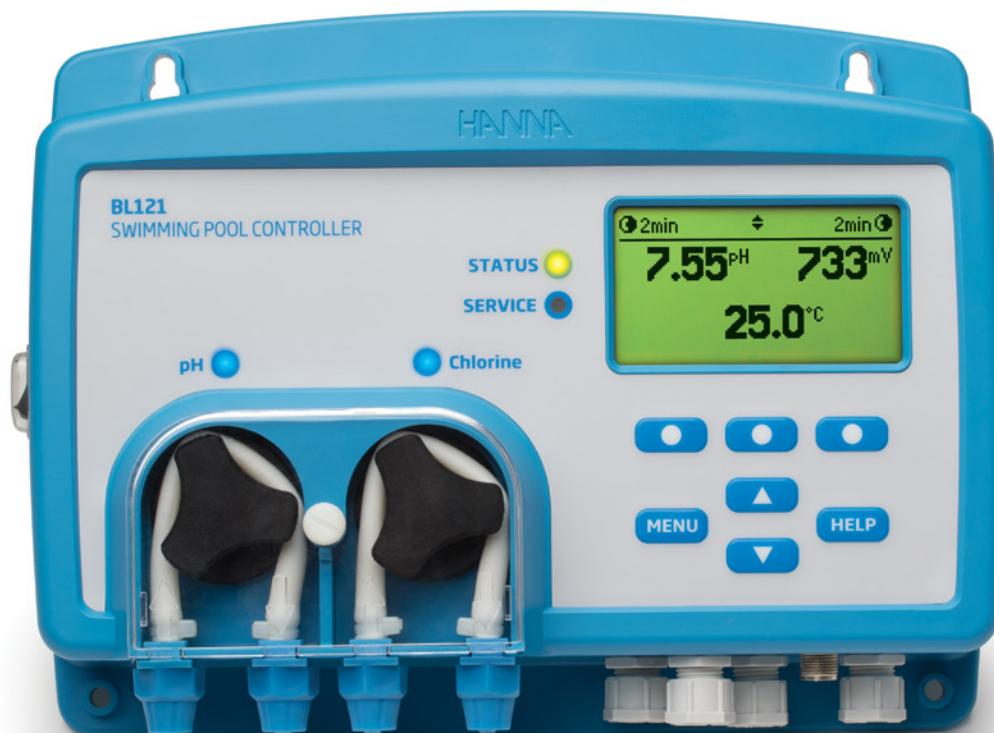
BL 121 kontroler je potpuno rješenje za održavanje bazena, hidromasažnih kada i praćenje kvaliteta vode za dezinfekciju u toplicama. BL 121 može imati dvije konfiguracije. Osnovna verzija se koristi pri kontinuiranom praćenju, sonda se direktno instalira a doziranje kemikalija se vrši preko postojećih cijevi. Verzija koja se montira na zid posjeduje protočnu čeliju koja služi za kalibraciju i održavanje sonde bez isključivanja cirkulacione pumpe.
