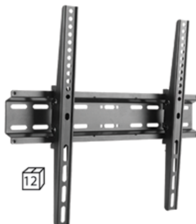
► ΚΩΔ.: KL25-44T 32"-55" MAX VESA 400x400 35kg ΑΠΟΣΤΑΣΗ ΑΠΟ ΤΟΙΧΟ 50mm ΚΛΙΣΗ +5 ~ -10°
