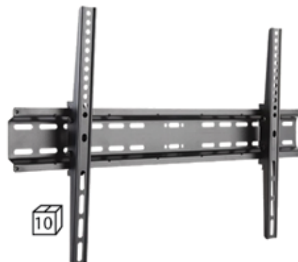
► ΚΩΔ.: KL25-46T 37"-70" MAX VESA 600x400 35kg ΑΠΟΣΤΑΣΗ ΑΠΟ ΤΟΙΧΟ 50mm ΚΛΙΣΗ +5 ~ -10°
