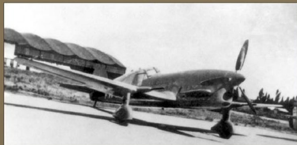
▶ Le C.710 avec son train fixe soigneusement caréné et ses canons d'aile. (Collection de l'auteur)
