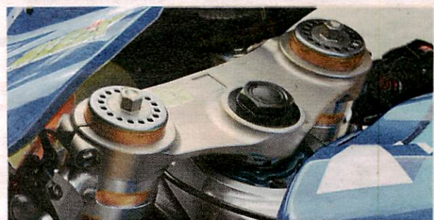
Grazilere Gabelbrücke am Motorrad von Aleix Espargaró
