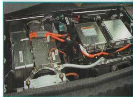
Fig. 23. Sistemul de baterii al unui vehicul Honda „Insight”
