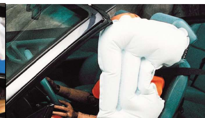
Fig. 27. Airbag montat în scaun, pentru impact lateral
