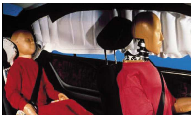
Fig. 26. Airbag tip perdea gonflabilă
