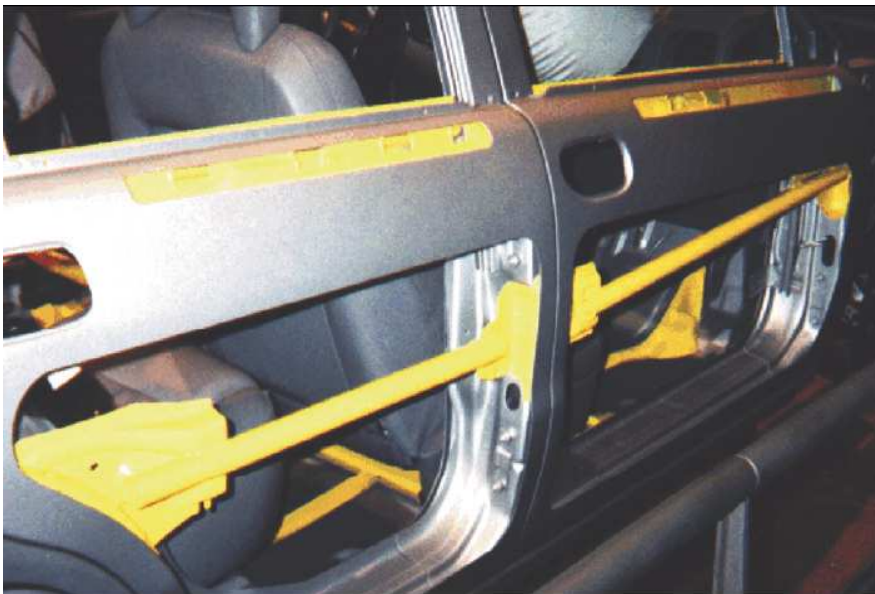
Fig. 17 Traversa de ranforsare din uși, pentru mărirea siguranței la impactul lateral, poate provoca, în cazul unei coliziuni frontale, dificultăți în înlăturarea ușilor (manual Holmatro)
