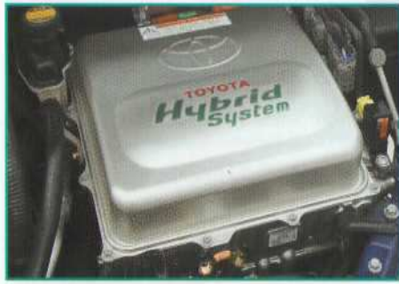
Fig. 22. Sistemul electronic de comandă al unui automobil Toyota „Prius”
