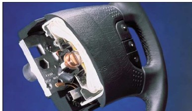
Fig.24. Secțiune transversală al unui airbag frontal
