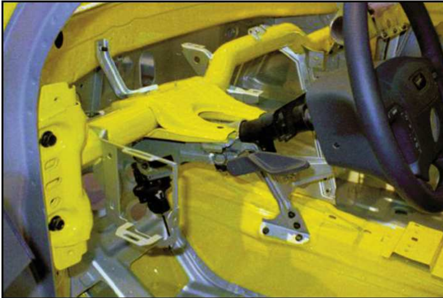
Fig. 16 Traversa de ranforsare din zona tabloului de bord poate afecta tehnicile folosite pentru rabatarea acestuia (manual Holmatro)
