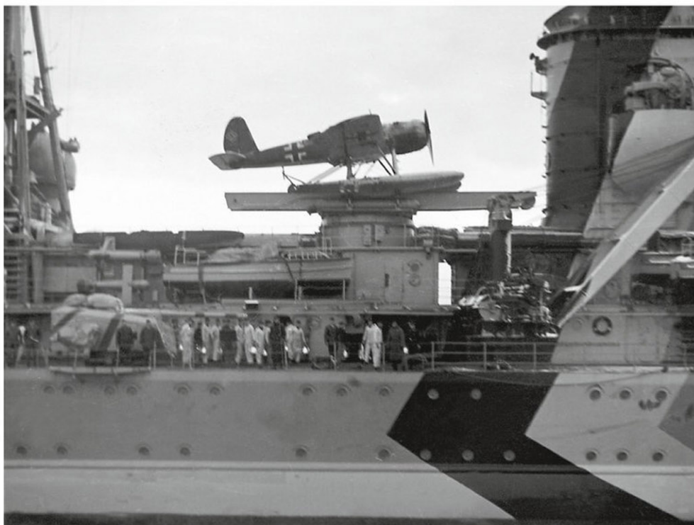
▲ Le flanc tribord milieu du Prinz Eugen revêtu de son camouflage Baltique en 1941, probablement à Kiel. Un des Arado Ar 196 est saisi sur la catapulte orientable.
