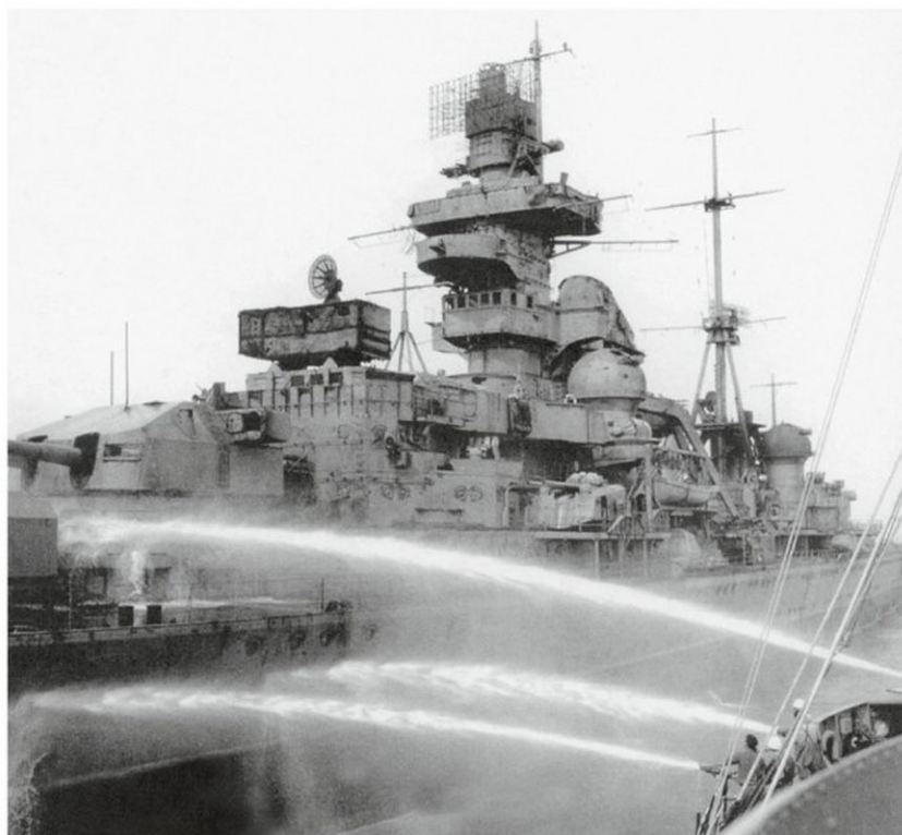
▲ Le IX-300 Prinz Eugen à Bikini en août 1946, après le second test atomique « Baker » du 25 juillet. Il est ici arrosé pour tenter de minimiser sa radioactivité afin de permettre l'inspection de ses dommages.
