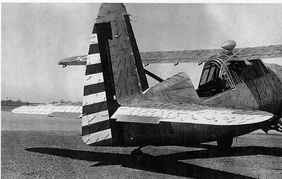
Les brins de laine fixés sur le fuselage pour visualiser l'écoulement autour de la cellule pendant le vol. (Collection William Webster)
