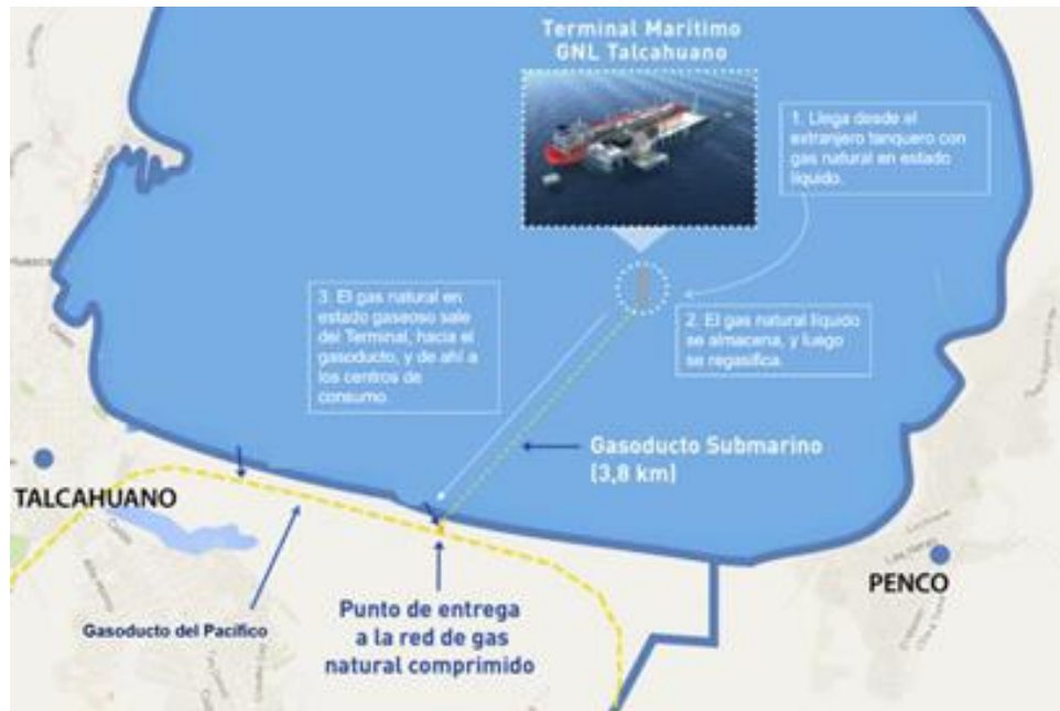
Figura 39: Infraestructura proyecto GNL Talcahuano
