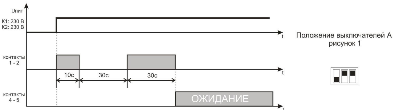
Рисунок 5 – Алгоритм работы реле “Управление (предпусковая сигнализация)”
