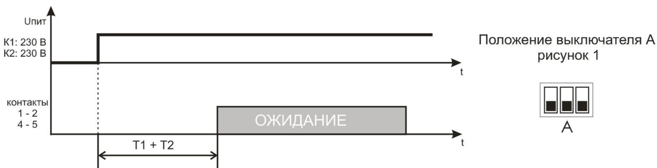
Рисунок 2 – Алгоритм работы реле “Задержка на включение”
