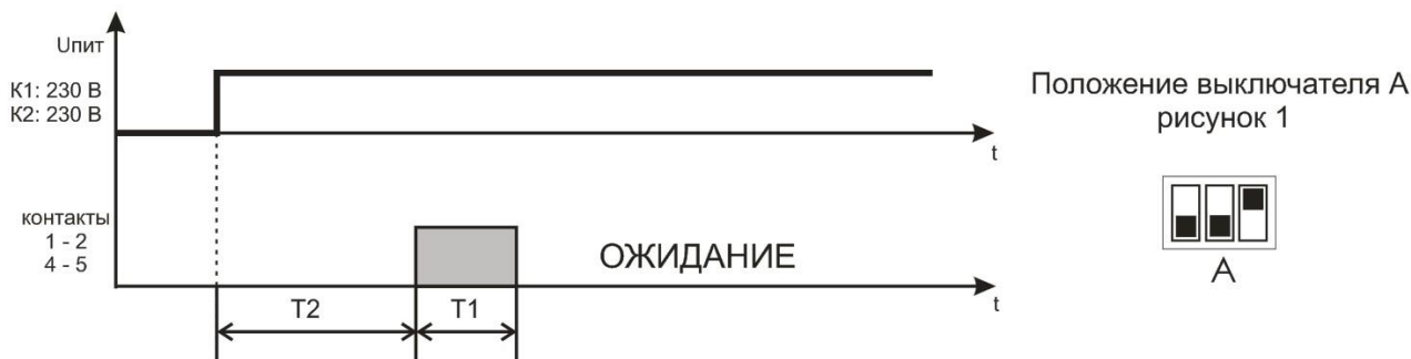
Рисунок 3 – Алгоритм работы реле “Импульсный 1”
