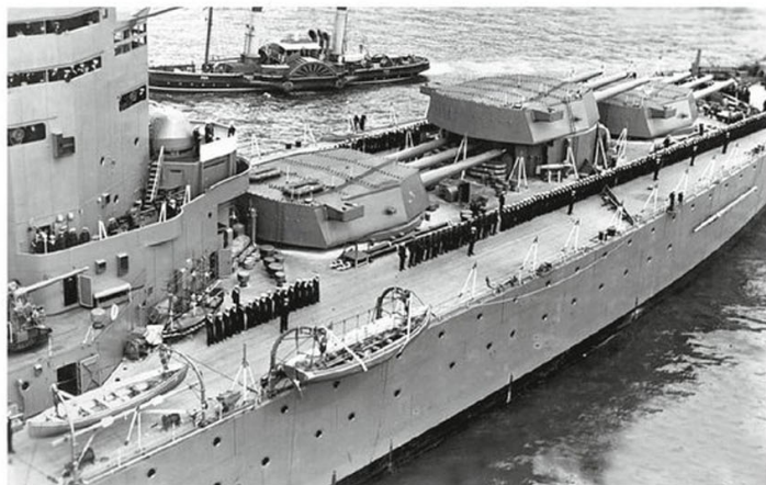
▼ Les trois tourelles triples de 406 mm du Nelson groupées à l'avant. Ayant montré certaines déficiences, cet armement ne sera pas retenu pour les Lion , dont le calibre principal prévu reste le même, mais est constitué de nouvelles pièces et masses pivotantes.
