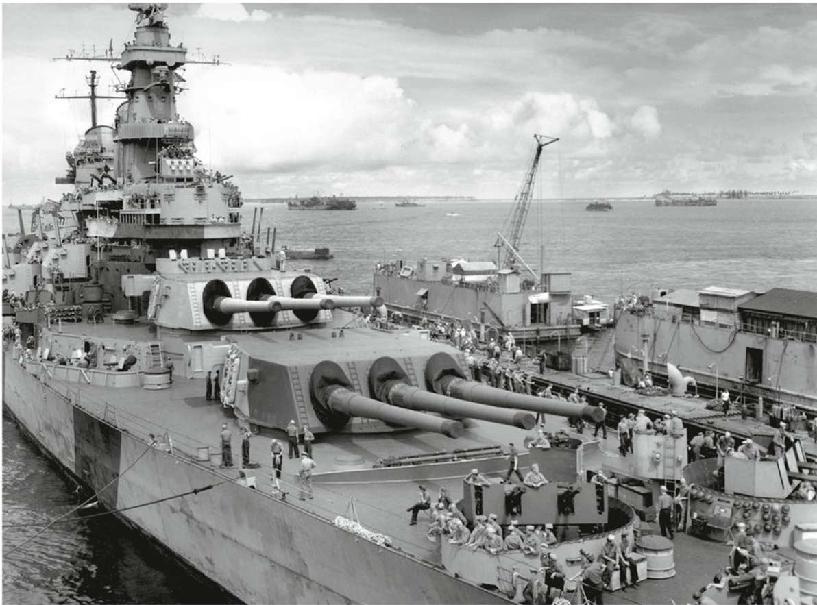
◀ L'Iowa à quai, montrant à nouveau ses deux tourelles triples avant de 406 mm, dans une disposition que devait reprendre la classe Montana, laquelle aurait disposé d'une tourelle arrière supplémentaire. US Nara
