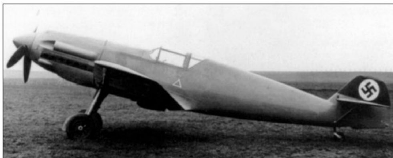
◀ Spécialement profilé et lustré et équipé d'un DB 601 R, capable de développer 1 650 ch pendant un temps très court, le V13 bat le record du monde de vitesse pour avions terrestres, le 11 novembre 1937, en atteignant 610,950 km/h. (Collection Nico Braas)
