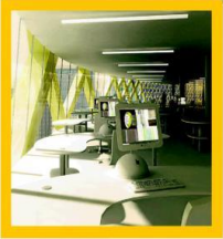
Au nord, la résille de béton est fine et laisse passer la lumière. Au sud, plus compacte, elle joue le rôle de pare-soleil.
