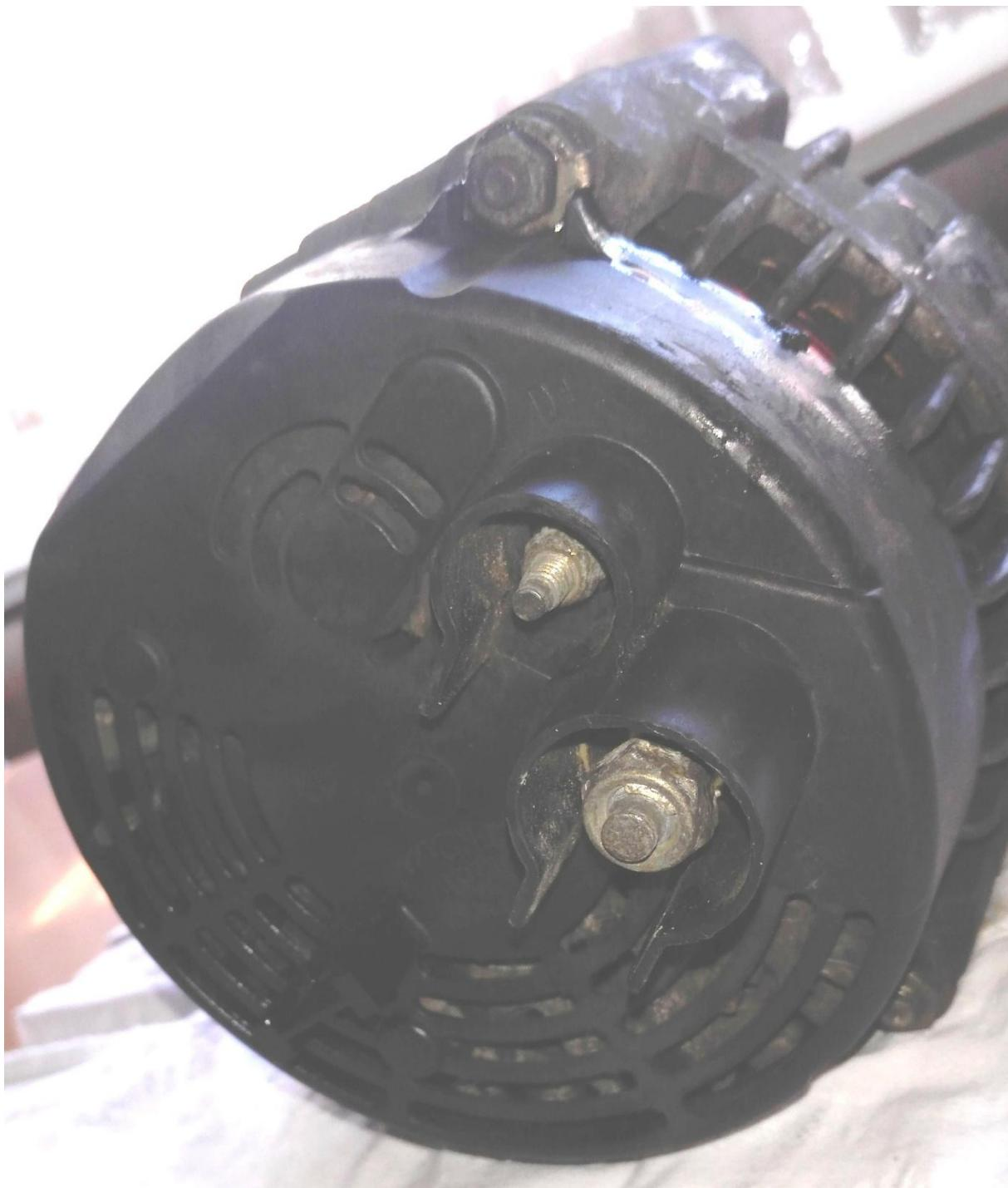
Diodni most ne može ukloniti dok se ne odvoje/odleme 3 izvoda statora koji je dio prednjeg kućišta alternatora.
