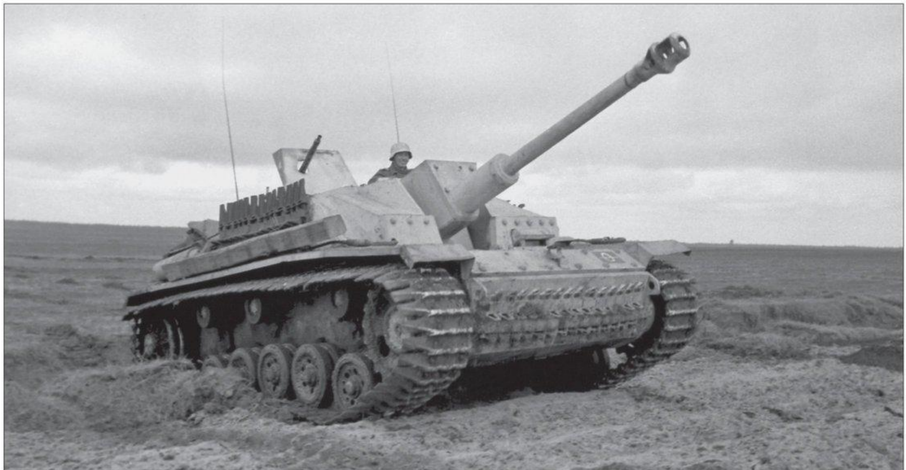
▲ Ce Stug III Ausf. G, produit avant juillet 1943, démontre que les Winterketten, ces chenilles conçues pour opérer dans la neige, sont également très efficaces en terrain sablonneux ; constat qui débouchera en 1944 sur la production des Ostketten, spécialement étudiées pour les terrains meubles de l'Ostfront. Tous les Stuges, à l'instar des autres unités de la Skijäger-Brigade, utilisent la MG-42 comme mitrailleuse de défense rapprochée, à la place de la MG-34.
