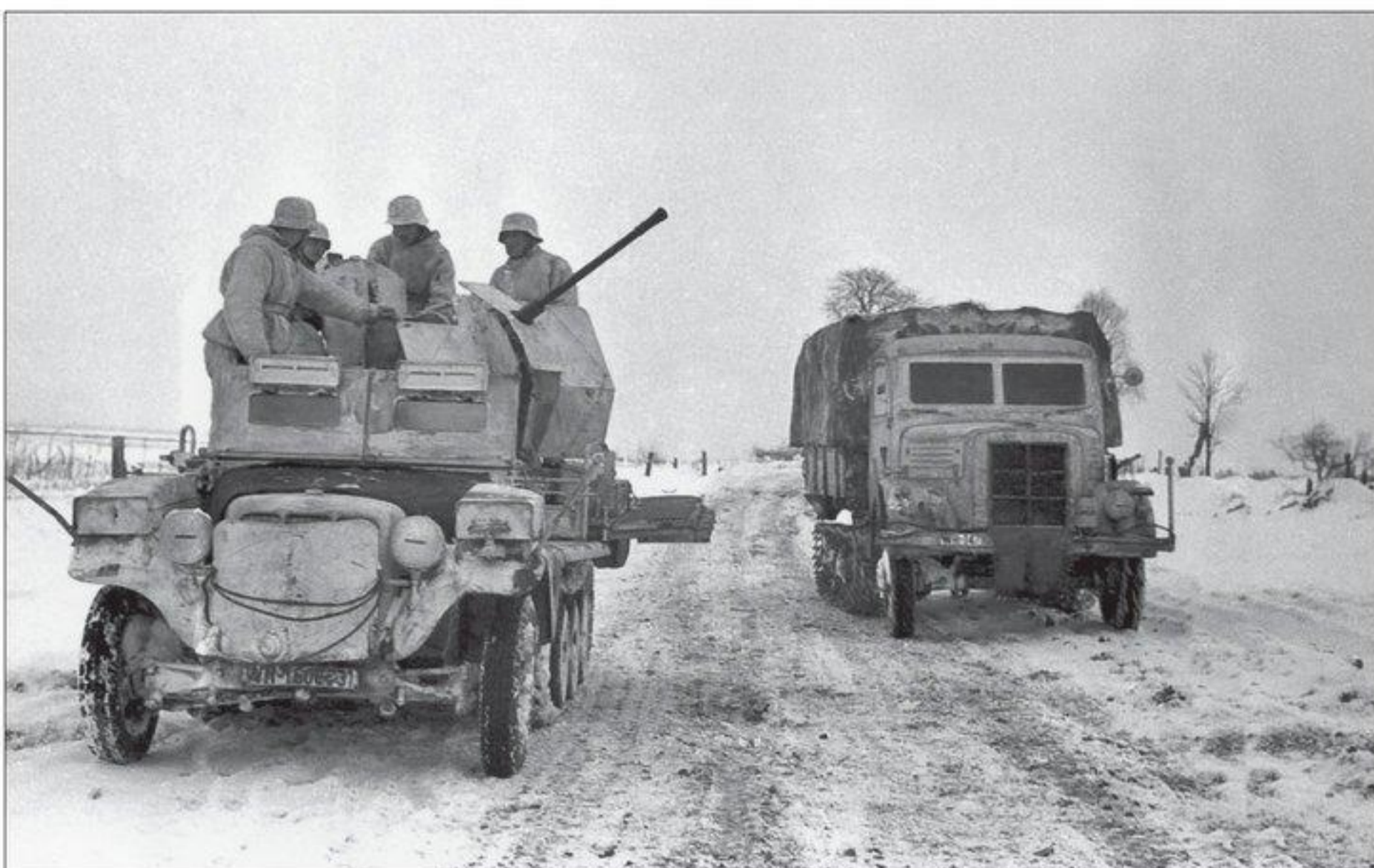
▲ Un Maultier classe 2 tonnes ( Sd.Kfz. 3 ) s'apprête à dépasser un Sd.Kfz. 10/5 . À partir de 1943, le haut de la cabine de conduite et la grille de calandre du tracteur sont renforcés par un blindage additionnel de 8 mm ( Befehlspanzerung ), mais les servants doivent se contenter de la maigre protection du bouclier du 2cm Flak 38 .
