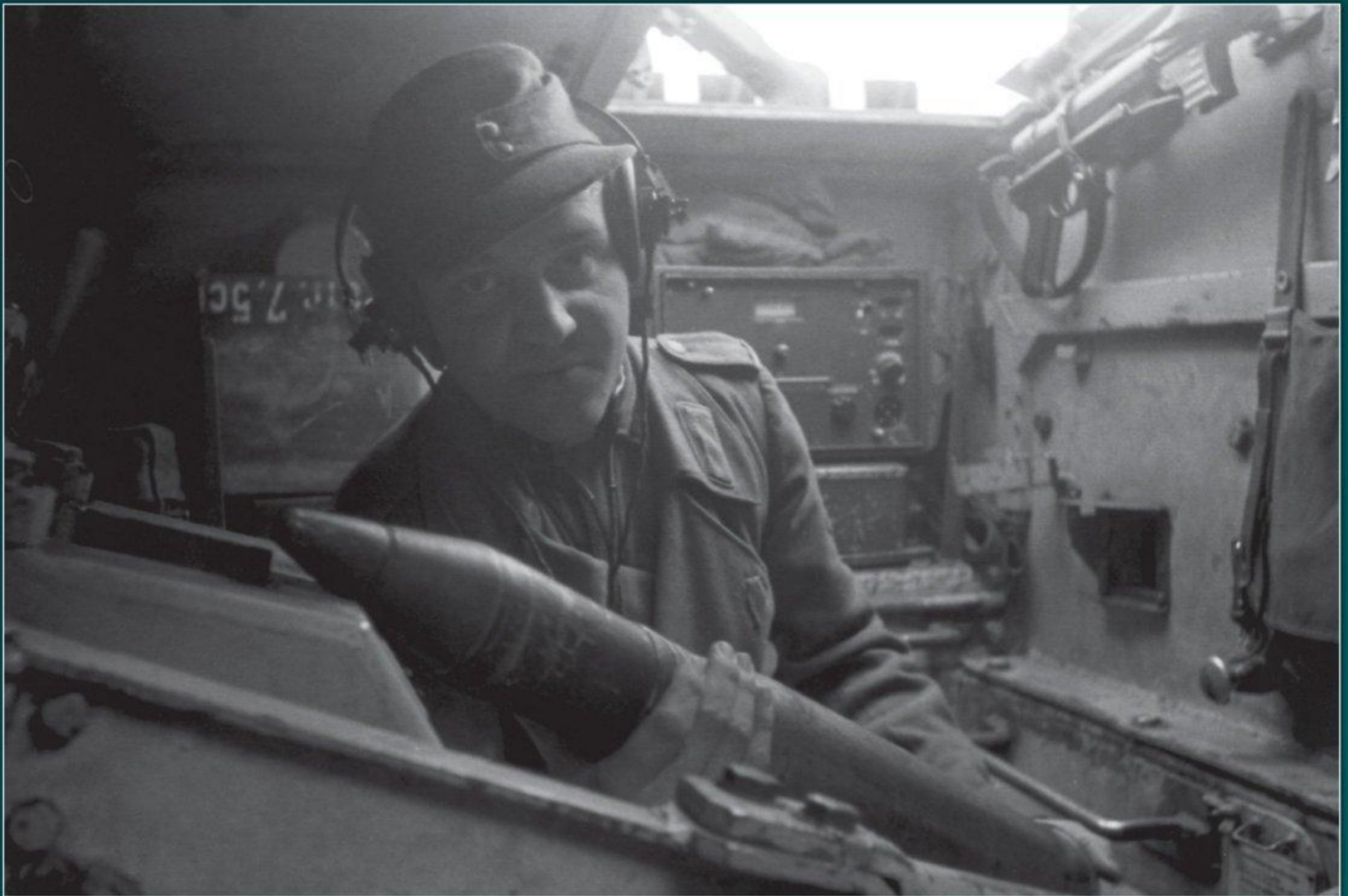
▲ Le pourvoyeur est le seul membre d'équipage positionné à la droite du canon. Il se prépare à engager une 7,5cm Panzergranatpatrone dans la culasse. Derrière lui, un FuG 15, récepteur à ondes ultra-courtes ; un MP-40 est fixé à la cloison pare-feu qui sépare l'habitacle du compartiment moteur.
