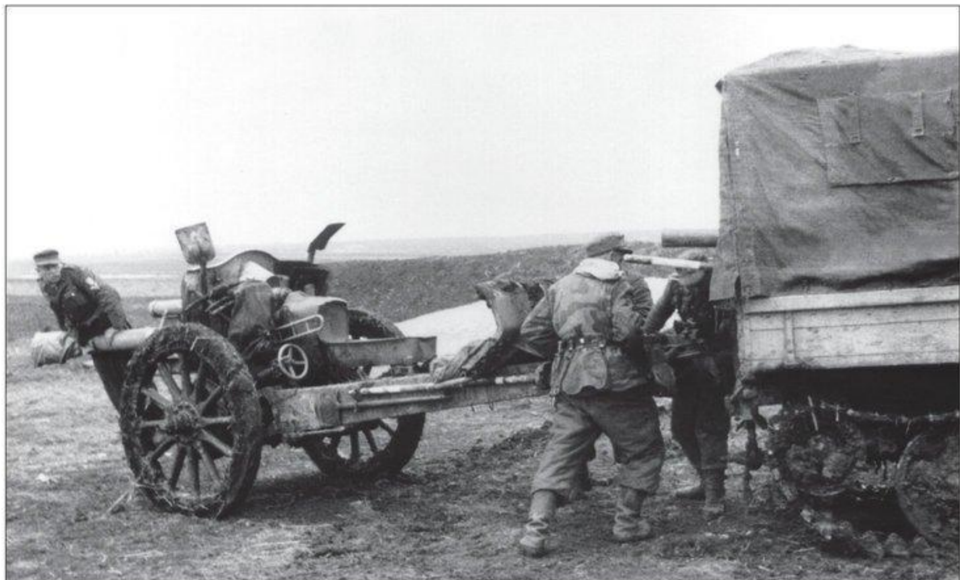
▲ Un artilleur fait la balance au bout du tube d'un 10,5cm le. FH 18M, pour faciliter l'amarrage des flèches au RSO. Archives Caraktère
