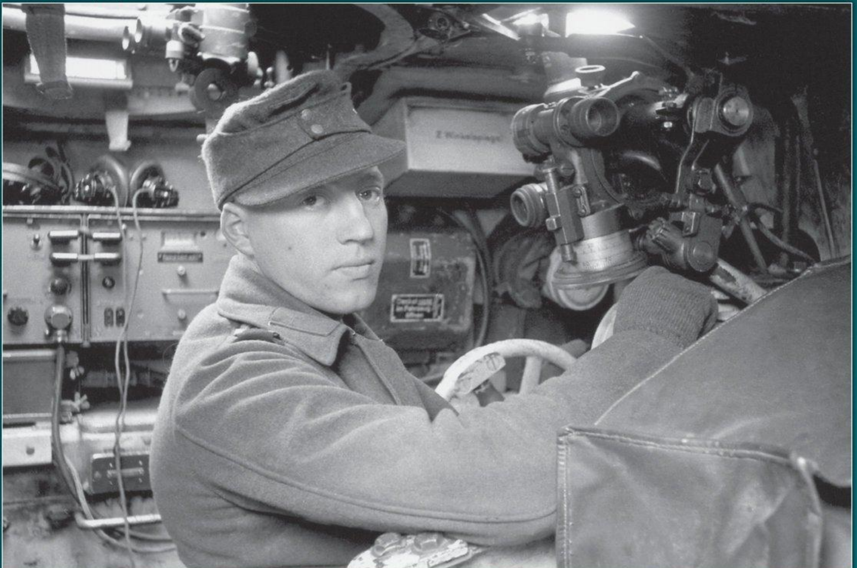
▲ Le pourvoyeur est le seul membre d'équipage positionné à la droite du canon. Il se prépare à engager une 7,5cm Panzergranatpatrone dans la culasse. Derrière lui, un FuG 15, récepteur à ondes ultra-courtes ; un MP-40 est fixé à la cloison pare-feu qui sépare l'habitacle du compartiment moteur.
