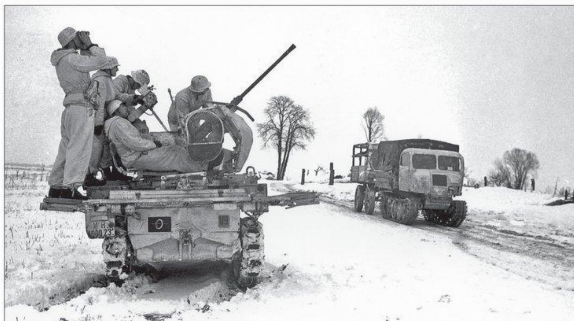
▲ « Sturmflak » affecté à la protection des lignes de ravitaillement de la brigade. Face aux Iliouchine soviétiques, le 2cm manque d'efficacité et ses munitions ricochent sur l'épais blindage de l'avion d'attaque au sol. À partir de l'été 1944, de préférence, les pièces simples ou multiples de 2cm seront engagées à l'Ouest, contre les Jabos anglo-américains moins blindés.
