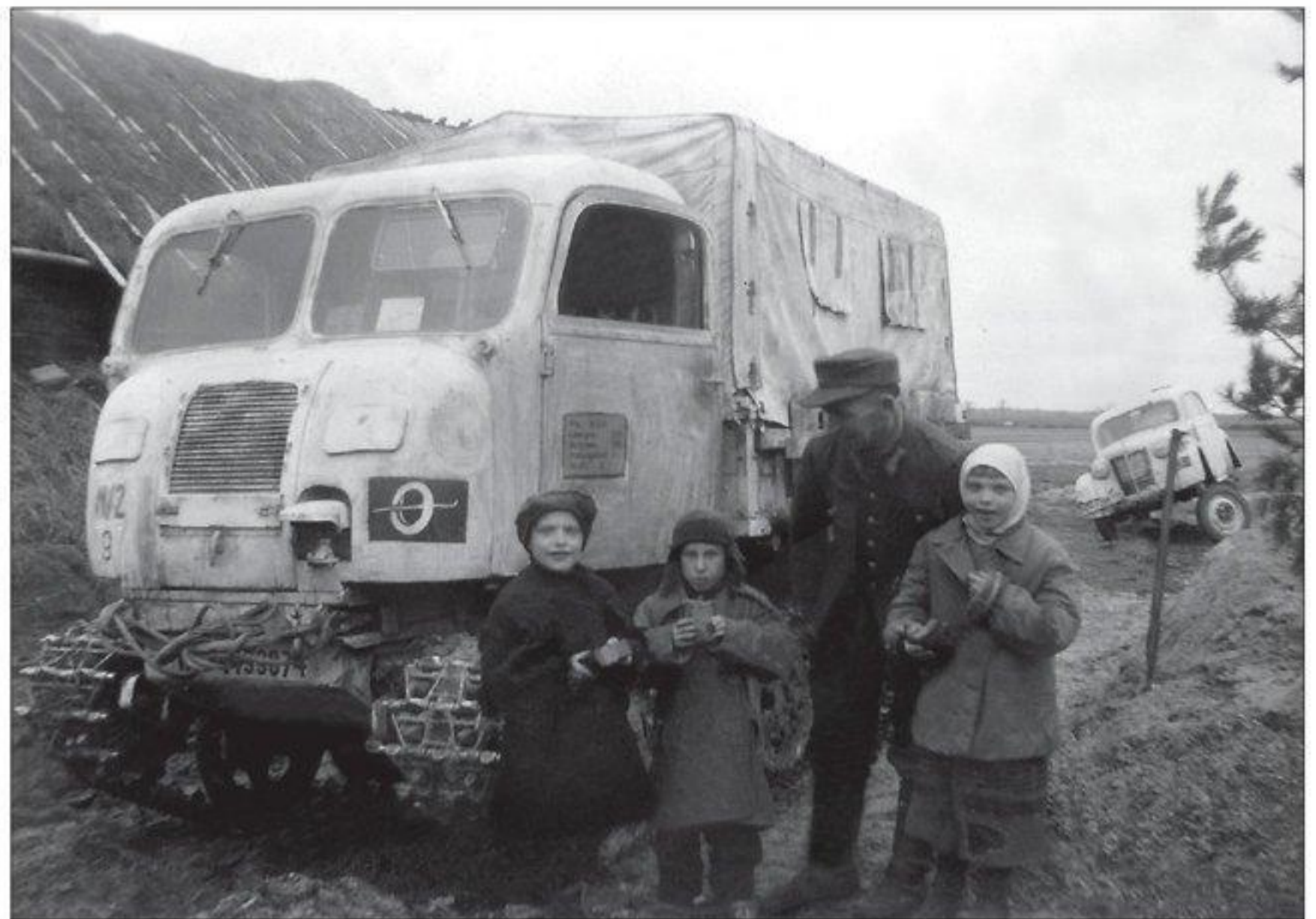
▲ À la 1. Ski-Brigade , les RSO sont répartis, à quelques exemplaires, dans les deux Stabs-Regimenter et la StuG-Brigade 270 . À noter, le dispositif de dégivrage électrique du pare-brise, côté conducteur. Archives Caractère
